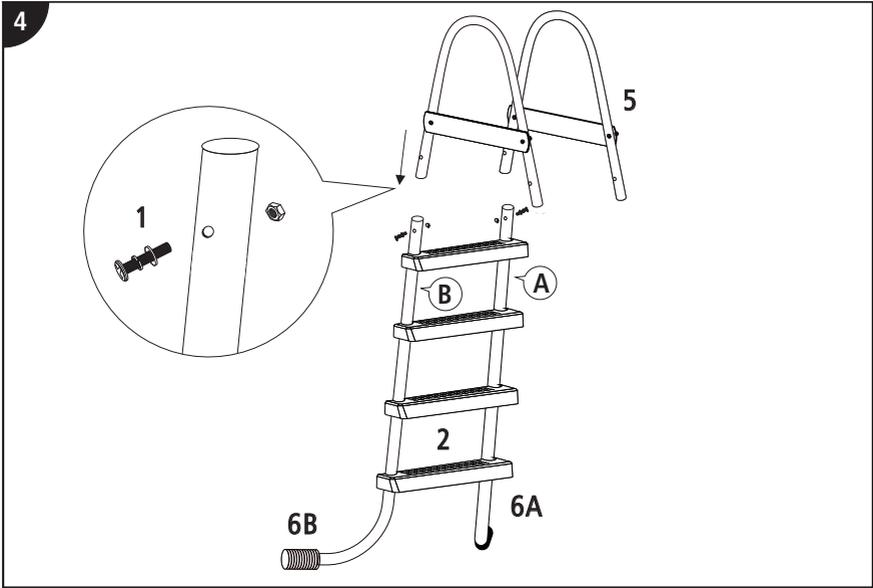
4. Montieren Sie die beiden oberen Handläufe (5), die Verbindungsstücke (4) nach außen gerichtet, mit je einer Befestigungsschraube, einem Federring, einer Unterlegscheibe und einer Hutmutter (1) auf eine der beiden in Schritt 1 vorbereiteten Stufenleiter.
