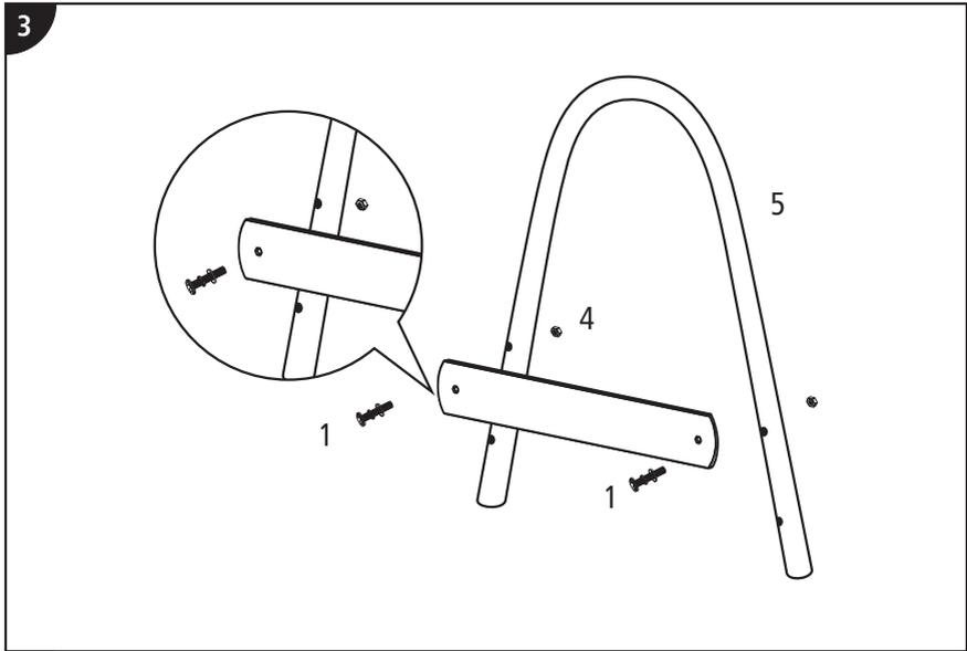
3. Montieren Sie je ein Verbindungsstück (4) mit zwei Befestigungsschrauben, Federringen, Unterlegscheiben und Hutmuttern (1) an einem oberen Handlauf (5).
