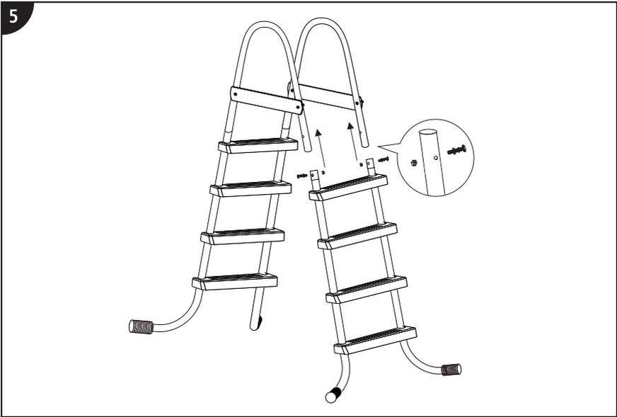
5. Montieren Sie die zweite in Schritt 1 vorbereitete Stufenleiter mit je einer Befestigungsschraube, einem Federring, einer Unterlegscheibe und einer Hutmutter (1) an die beiden oberen Handläufe (5).
