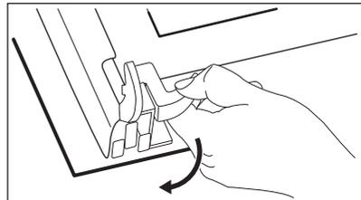
5. Drehen Sie die Befestigungen um 90° und nehmen Sie sie aus der Halterung.
