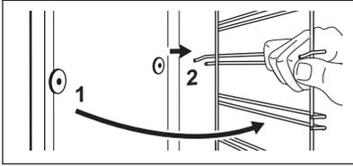
4. Setzen Sie die Einhängegitter in umgekehrter Reihenfolge ein.
