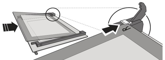
**4.** Die obere Ecke wieder anbringen: ein Klick bestätigt die richtige Positionierung. Sicherstellen, dass die Dichtung vor Wiedereinbau der Tür befestigt wird.
