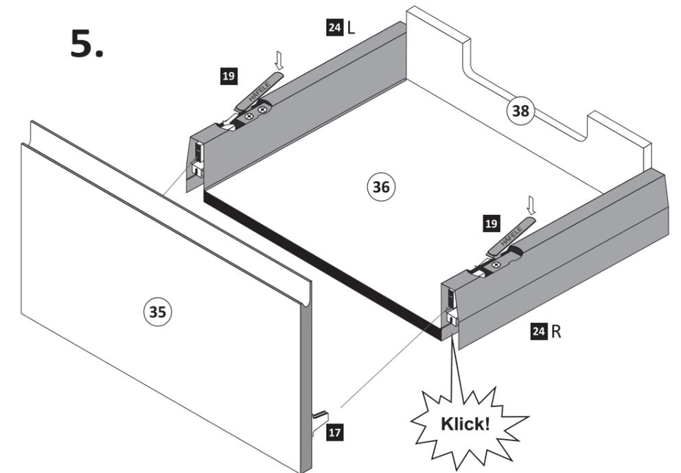
Führen Sie die Schubkastenblende **35** mit dem Beschlag **17** wie abgebildet in die Zargen **24** ein. Der Beschlag **17** rastet ein!
