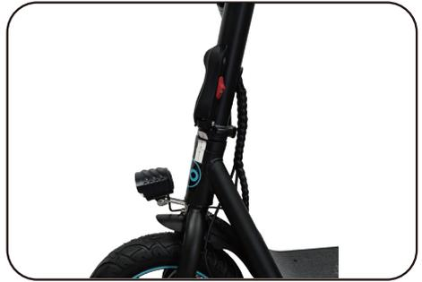
Drücken Sie den Hebel fest in Richtung Lenksäule, bis er verriegelt.
