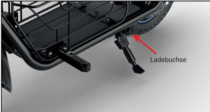
1. Die Ladebuchse befindet sich wie abgebildet am hinteren Ende des Trittbretts.
