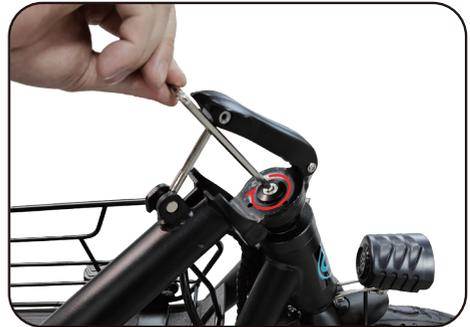
Ziehen Sie die Schraube fest an, um eine ordnungsgemäße und Lenkfunktion sicherzustellen.
