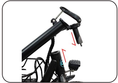
Öffnen Sie den Klappmechanismus bis zum auf dem Bild ersichtlichen Winkel.
