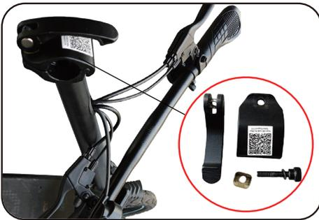
Öffnen Sie den Schnellspanner und entfernen Sie die markierten Teile.
