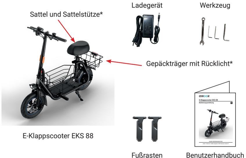
\*Lenksäule, Lenkstange, Fußrasten, Sattel und Gepäckträger müssen vor der Inbetriebnahme montiert werden (Seite 8)
