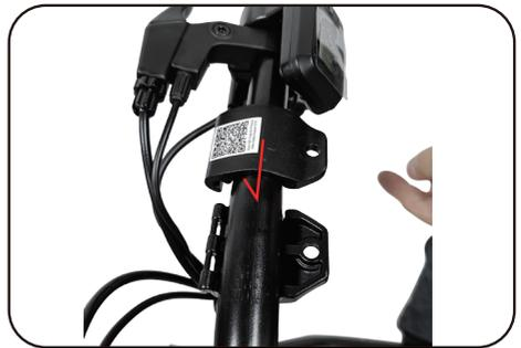
Zentrieren Sie die Lenkstange auf der Lenksäule und schieben Sie die obere Lenkstangenhalterung in die Führung auf der Lenksäule.
