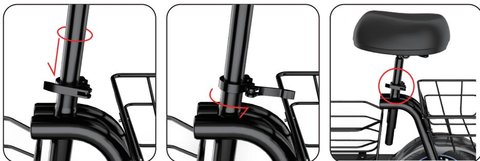
Öffnen Sie den Schnellspanner an der Sattelstützenaufnahme am Rahmen und führen Sie die Sattelstütze ein. Stellen Sie die Sitzhöhe auf eine bequeme Position ein und schließen dann den Schnellspanner.
