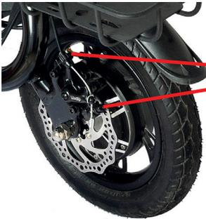
Schrauben der Bremssattelbefestigung
