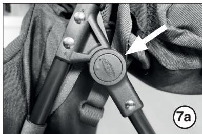
Am Gelenk des Ständers finden Sie rechts und links einen Knopf. Um den Ständer auszuklappen bzw. einzuklappen, drücken Sie die beiden Knöpfe gleichzeitig. Halten Sie die Knöpfe gedrückt und klappen Sie den Ständer ein bzw. aus.
