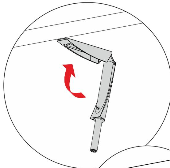
Durch Herein- oder Herausdrehen des Stiftes die Position der Front soweit einstellen, bis diese sich gut schliessen und (durch Drücken) öffnen lässt. Die veränderte Position des Stiftes sehen Sie nur bei eingedrücktem Stiff.
