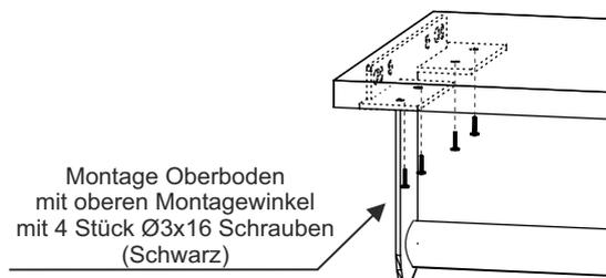
13. Montieren Sie die Garderobenstange an dem Bolzen des oberen Montagewinkel. (Abb.8)
