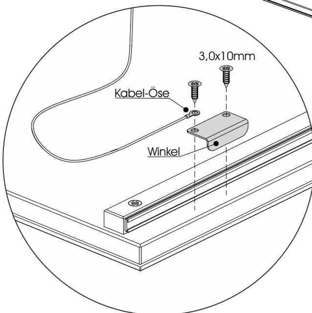
**5** Den Winkel mit der Kabel-Öse wie dargestellt an den Spiegel schrauben
