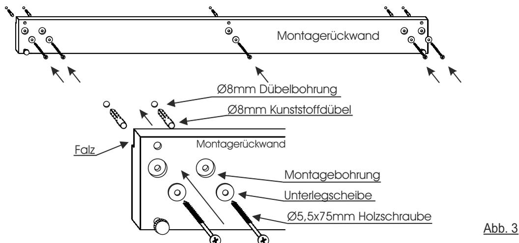
7. Überprüfen Sie nach der Montage der Rückwand ob diese waagrecht montiert wurde. Eine nachträgliche Justierung ist nicht möglich.
