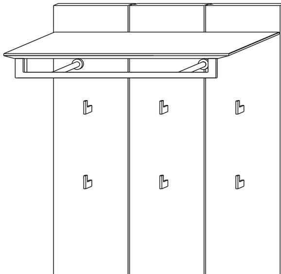
8. Richten Sie zum Schluss das Paneel mit Hilfe der Stellschrauben der Aufhängebeschläge aus.
