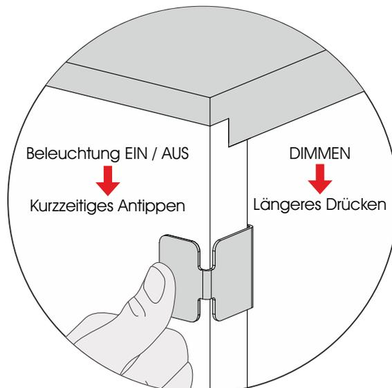
Bei anhaltendem Druck auf den Berührungsschalter dimmt die Beleuchtung abwechselnd auf und ab. Sobald der gewünschte Dimmgrad erreicht ist den Druck vom Berührungsschalter nehmen. Der erreichte Dimmgrad wird gespeichert und bleibt bei den nächsten Schaltvorgängen erhalten.
