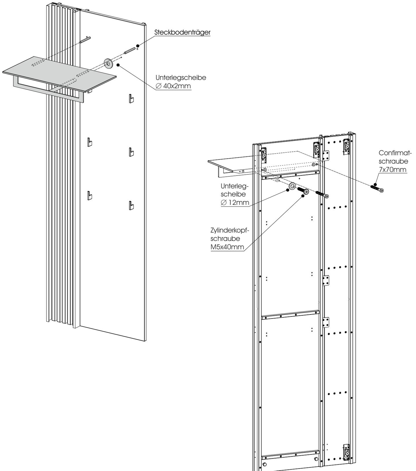
Die Aufhängeschienen entsprechend den vormontierten Aufhängebeschlägen (auf der Rückseite des Panels) an die Zimmerwand montieren
