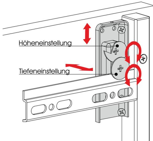
Durch Drehen der beiden Stellschrauben können die Tiefe die die Höhe des Regalpaneelles eingestellt werden
