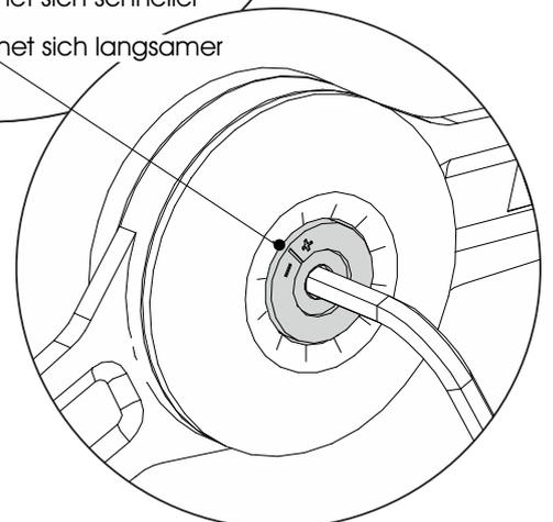
TIP-ON Dämpfer Montage und Einstellung
