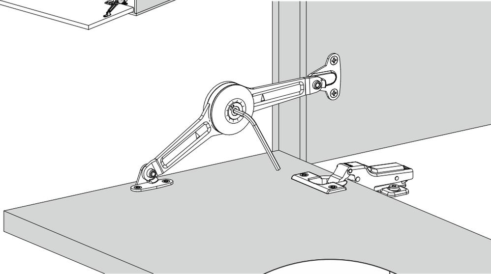
Durch Drehen der Stellschraube am Klappenhalter kann die „Öffnungsgeschwindigkeit“ der Klappe eingestellt werden. Stellen Sie den Klappenbeschlag so ein, dass sich die Klappe sanft öffnet.
