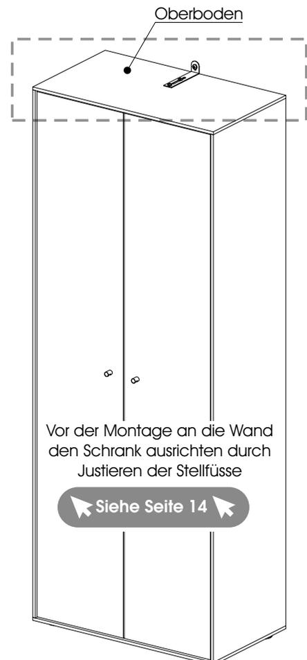
Wandbefestigungen immer unbedingt durchführen und die Schränke und Korpusse lotgerecht ausrichten! Nur so ist gewährleistet, dass die Fronten korrekt eingestellt werden können.
