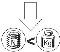
Um Verletzungsgefahren auszuschließen, stellen Sie die Stellschraube des Klappenhalters so ein, dass die Klappe sanft nach unten schließt. Durch Drehen der Stellschraube am Klappenhalter kann die Schließgeschwindigkeit der Klappe eingestellt werden.
