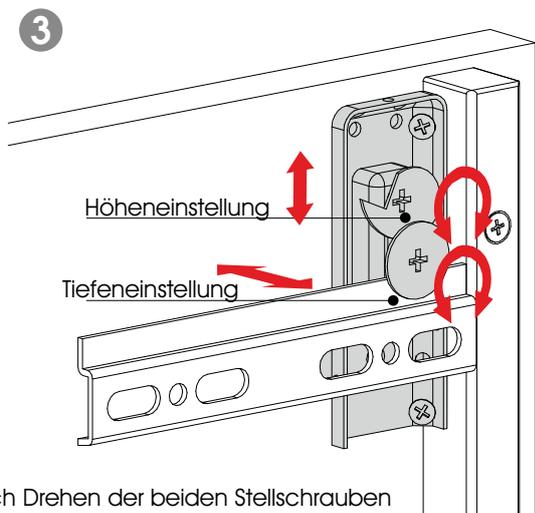
Durch Drehen der beiden Stellschrauben können die Tiefe die die Höhe des Regalpaneelles eingestellt werden
