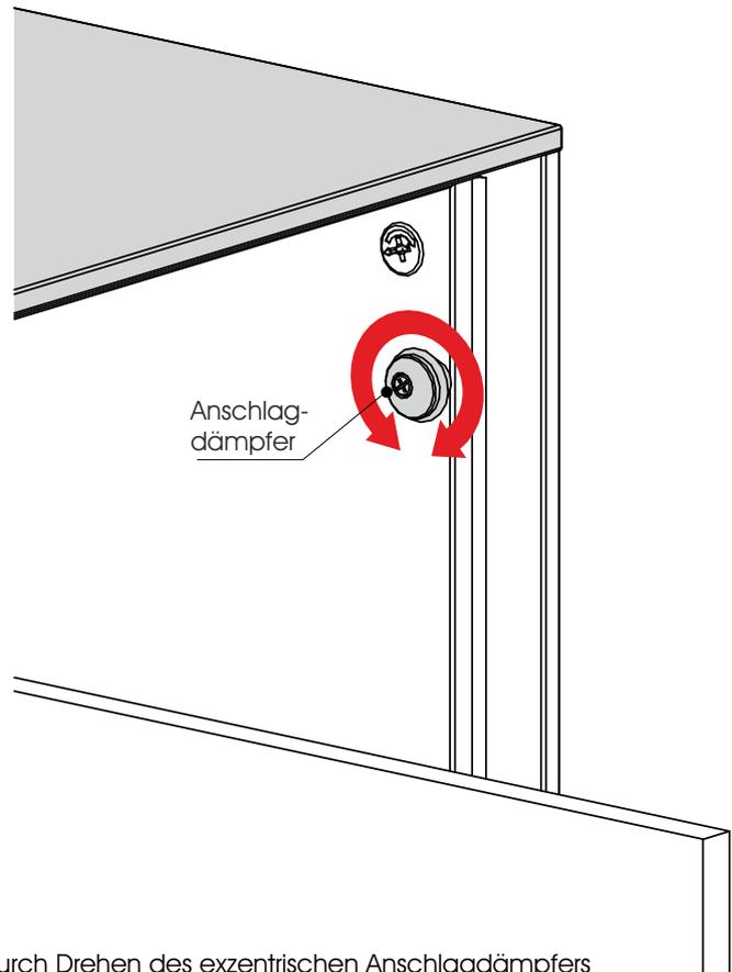
Durch Drehen des exzentrischen Anschlagdämpfers kann die Tür so eingestellt werden, dass diese oben und unten gleichmäßig anliegt.
