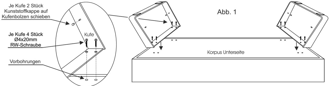
3. Schieben Sie auf die vier Kufenbolzen, auf denen später der Metallboden aufliegt, eine Kunststoffkappe auf. (Abb. 1)
