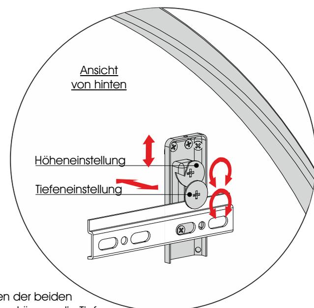
Durch Drehen der beiden Stellschrauben können die Tiefe und die Höhe des Paneels eingestellt werden. Die Einstellungen können nur von hinten vorgenommen werden.
