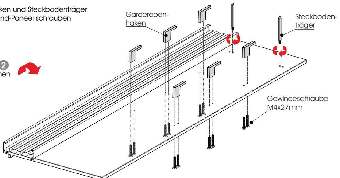
**4** Den Ablageboden an das Rückwand-Paneel schrauben
