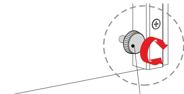
Durch Drehen dieser Stellschrauben kann die Neigung des Regalpaneelles verändert werden
