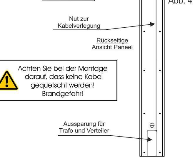
**!** Achten Sie bei der Montage darauf, dass keine Kabel gequetscht werden! Brandgefahr!
