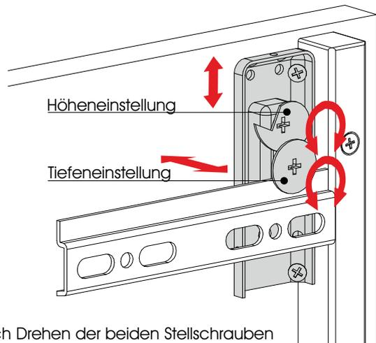
Durch Drehen der beiden Stellschrauben können die Tiefe die die Höhe des Regalpaneeles eingestellt werden
