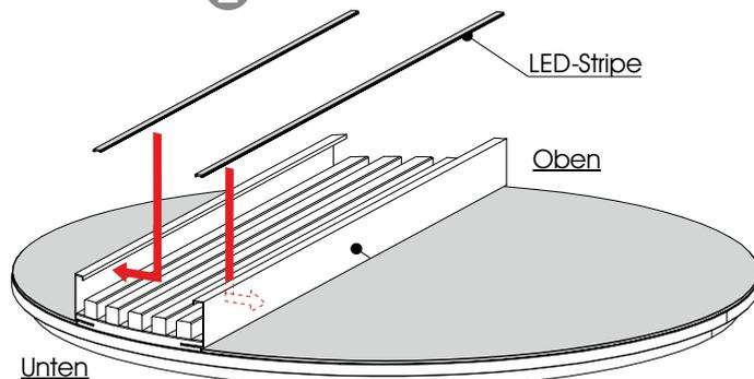
Achten Sie bitte darauf, dass der kürzere LED-Stripe an das kürzere und der längere LED-Stripe an das längere Alu-Profil geklebt wird!
