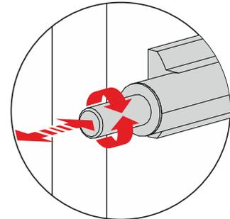
Durch Herein- oder Herausdrehen des Stiftes die Position der Front soweit einstellen, bis diese sich gut schliessen und (durch Drücken) öffnen lässt.
