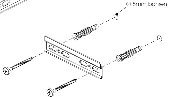
Die Aufhängeschiennn entsprechend den vormontierten Aufhängebeschlagn (auf der Rückseite des Regalpaneelles) an die Zimmerwand montieren
