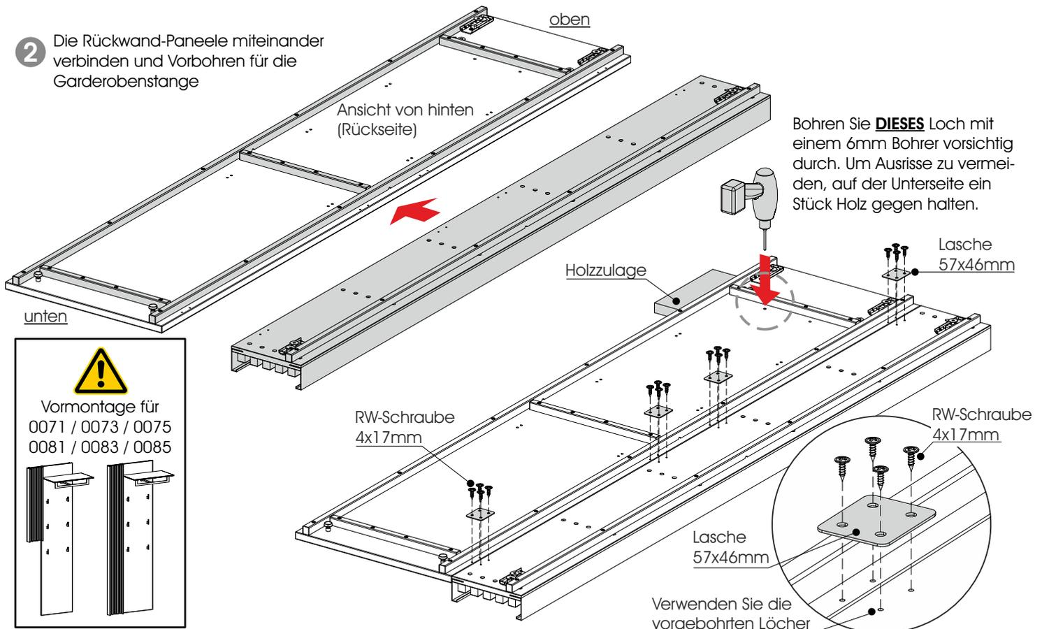
Bohren Sie **DIESES** Loch mit einem 6mm Bohrer vorsichtig durch. Um Ausrisse zu vermeiden, auf der Unterseite ein Stück Holz gegen halten.
