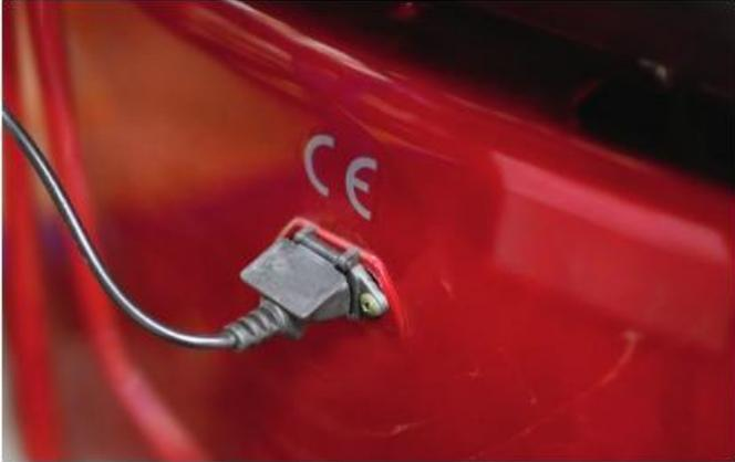
Laden Sie den Best Ager über die Ladebuchse, die sich halb unter der Sitzbank befindet. Verbinden Sie das mitgelieferte Ladegerät mit der Ladebuchse am Best Ager und mit einer 220V Netzsteckdose.
