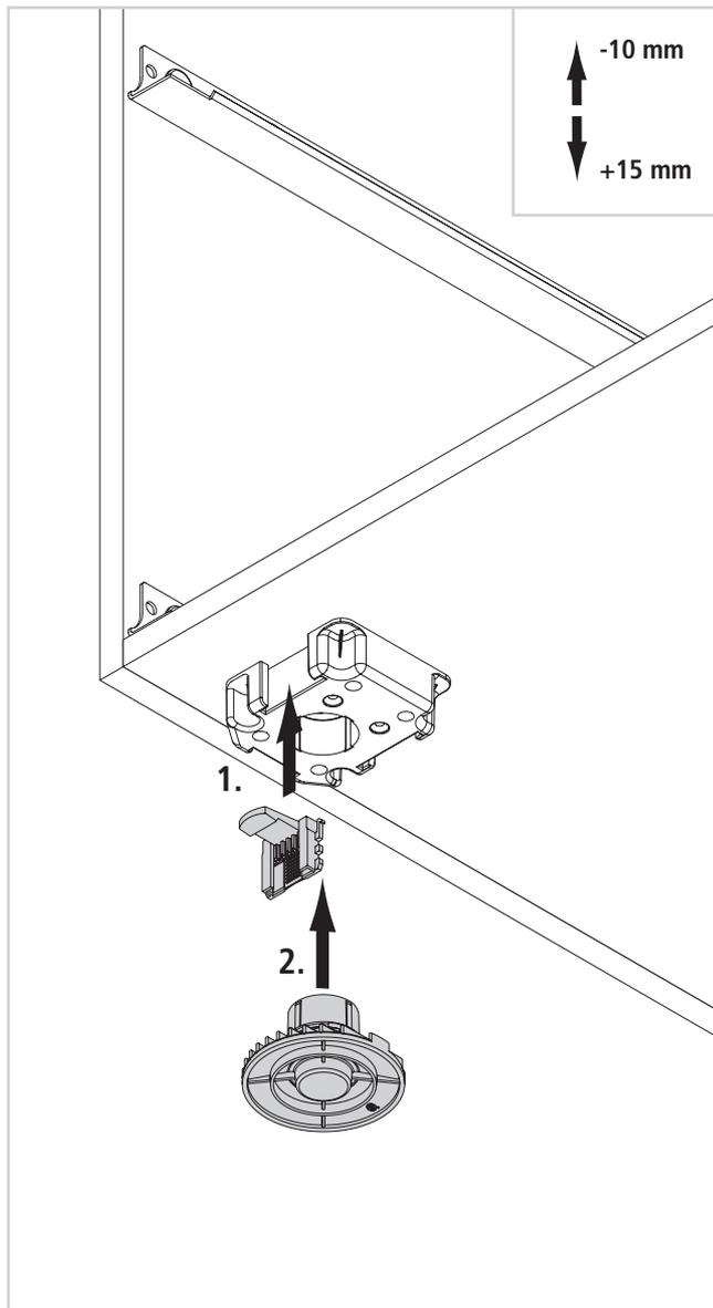
DE - Stellfuß - Befestigung / GB - Adjustment foot - fixing / FR - Pied - Fixation / NL - Stelpoot - bevestiging / ES - Fijación patas de ajuste
