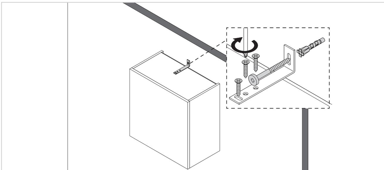
DE - Kippsicherung / GB - Anti-tipping device / FR - Anti-renversement / NL - Kantelbeveiliging / ES - Sistema de seguridad antivuelcos
