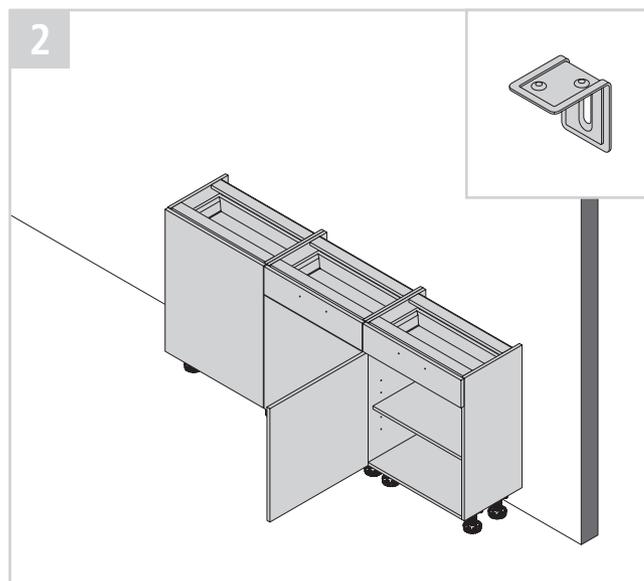
DE - Kippsicherung / GB - Anti-tipping device / FR - Anti-renversement / NL - Kantelbeveiliging / ES - Sistema de seguridad antivuelcos
