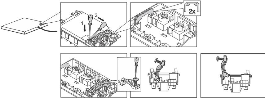
1. Öffnen Sie die Abdeckung des Anschlussklemmenkastens.
