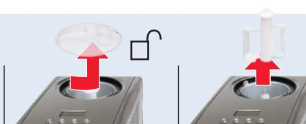
Deckel und Rührwelle entfernen
