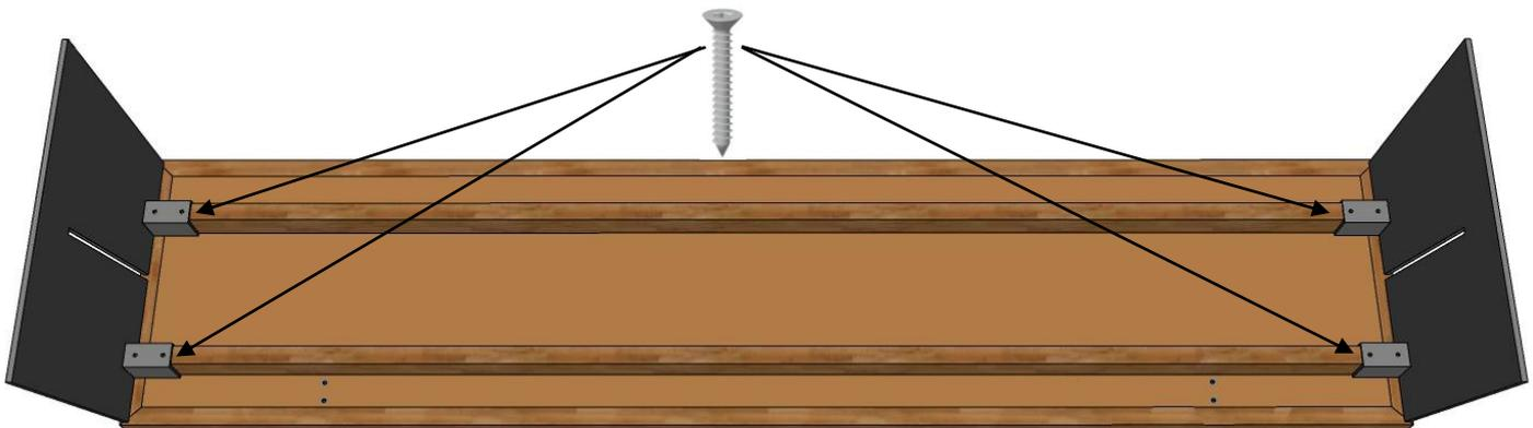
Die Stahlwangen mit 8 Schrauben (5x80) an der Sitzfläche befestigen.
