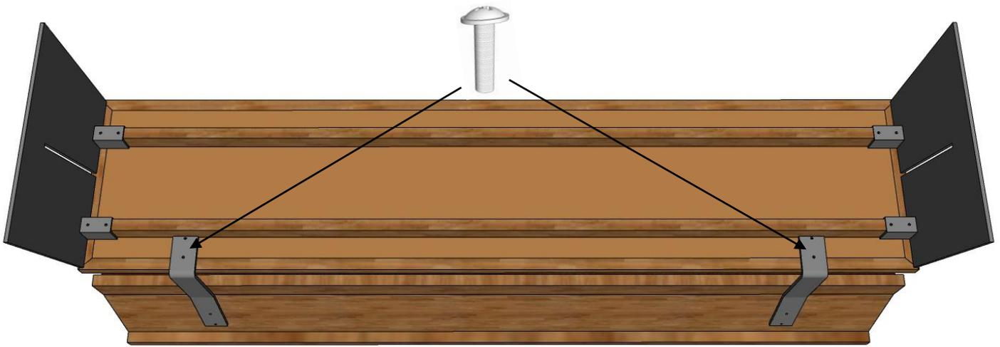
**Die Rücklehne wird mit 4 Stück Schrauben (M6x30) an der Sitzfläche befestigt.**
