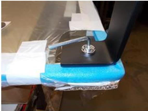
Die 2 Bügel auf die Klebeteile aufsetzen, dann die Chromrosetten und Schrauben in **den mittleren Sackloch** des Klebeteils fest verschrauben
