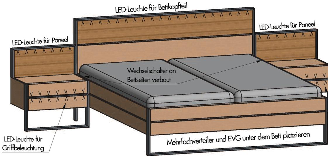
1. LED Leuchten in Mehrfachverteiler stecken
