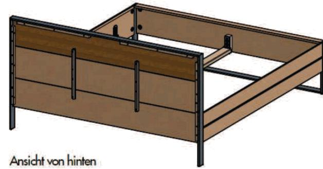
Befestigungspunkte (Bohrung Ø8mm) für Steel Hängenachtkonsole mit Großraumschubkasten 155025
