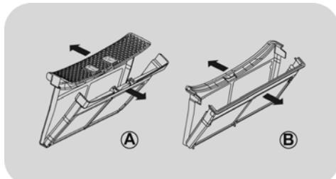
3. Entfernen Sie Fusseln aus beiden Filtern vorsichtig mit den Fingerspitzen oder mit einer weichen Bürste, einem Tuch oder unter fließendem Wasser.
