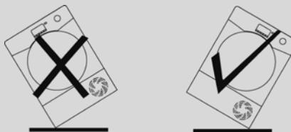
Si le produit est transporté différemment, attendez au moins 4 heures avant d'allumer l'appareil, ceci afin que le gaz liquide retourne dans le compresseur. En cas de non respect de cette procédure, le compresseur pourrait être endommagé.
