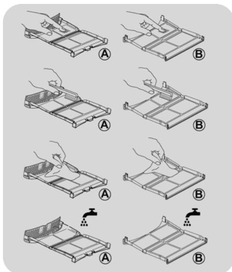
4. Schließen Sie beide Filter, indem Sie sie wieder in die Tür einsetzen und dabei sicherstellen, dass sie richtig positioniert sind.
