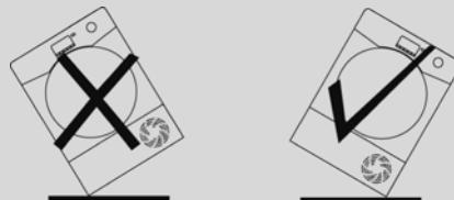
**Wenn das Gerät in eine andere Lage transportiert wurde, warten Sie mindestens 4 Stunden, bevor Sie es einschalten, damit sich die Flüssigkeit im Kompressor wieder stabilisieren kann. Tun Sie es nicht, können Schäden am Kompressor die Folge sein.**
