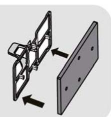
6. Rimontare il telaio del filtro in spugna assicurandosi che sia nella posizione corretta.
