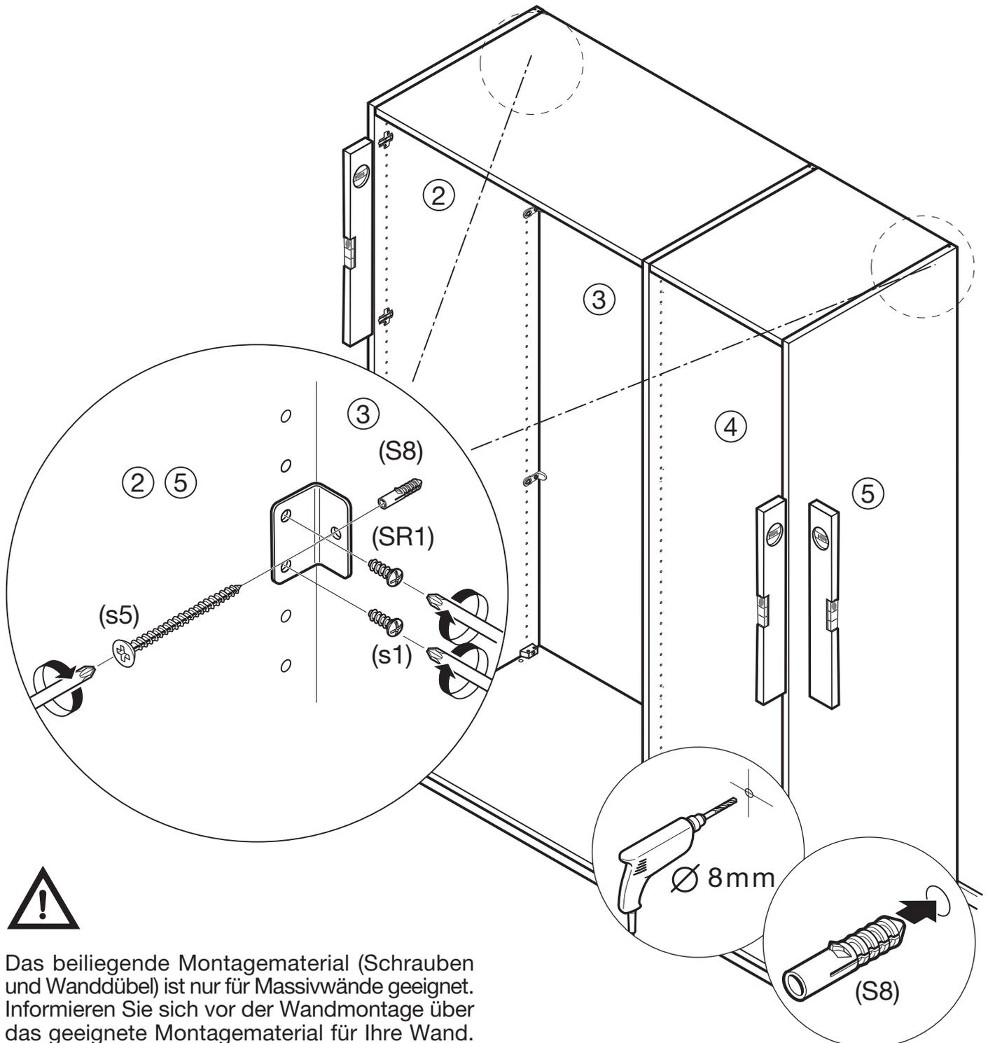
Das beiliegende Montagematerial (Schrauben und Wanddübel) ist nur für Massivwände geeignet. Informieren Sie sich vor der Wandmontage über das geeignete Montagematerial für Ihre Wand.
