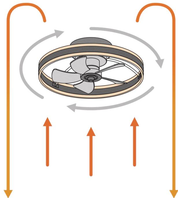
En été, le ventilateur souffle vers le bas afin de créer une sensation de fraîcheur grâce au mouvement de l'air.
