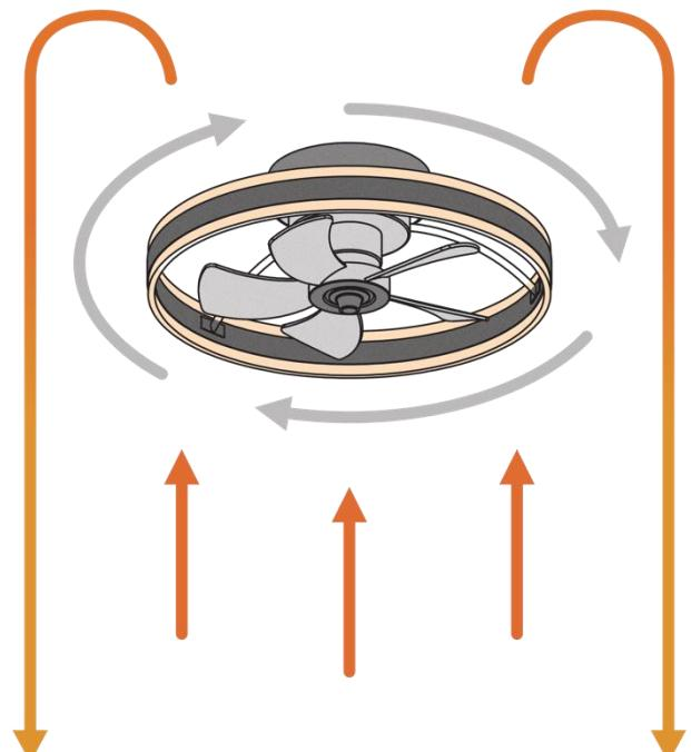
Ko se vklopi vzvratna funkcija ventilatorja, se začne vrteti v nasprotni smeri, tako da topel zrak, ki se nabira na stropu, steče na tla in tako pozimi ogreje prostor.
