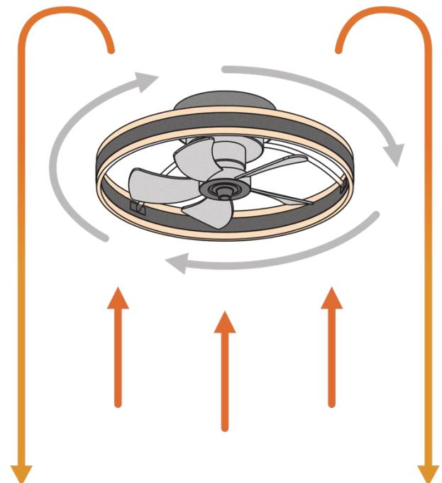
När fläktens omvänta funktion slås på börjar den rotera i motsatt riktning så att varm luft som samlas i taket strömmar ner till golvet och varmer rummet på vintern.
