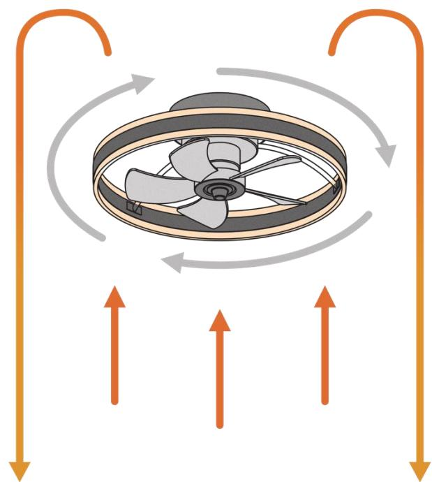
Kada uključite funkciju ventilatora u suprotnom pravcu, ventilator počinje da se okreće u suprotnom pravcu, tako da se topli vazduh akumuliran na plafonu spušta na pod i na taj način zimi zagreva prostoriju.
