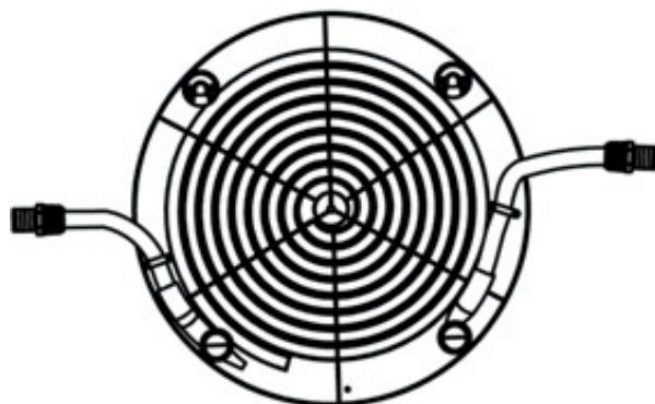
Přimontujte oba adaptéry do spodní části solárního ohřívače
