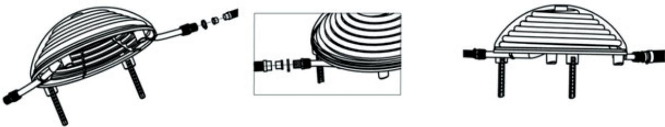
Raccord tuyau 32 mm: celui-ci est enfoncé directement dans l'adaptateur de raccordement et fixé avec le collier de serrage.
