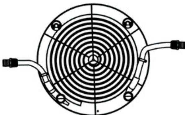
Asamblați cele 2 adaptoare în partea inferioară a încălzitorului solar
