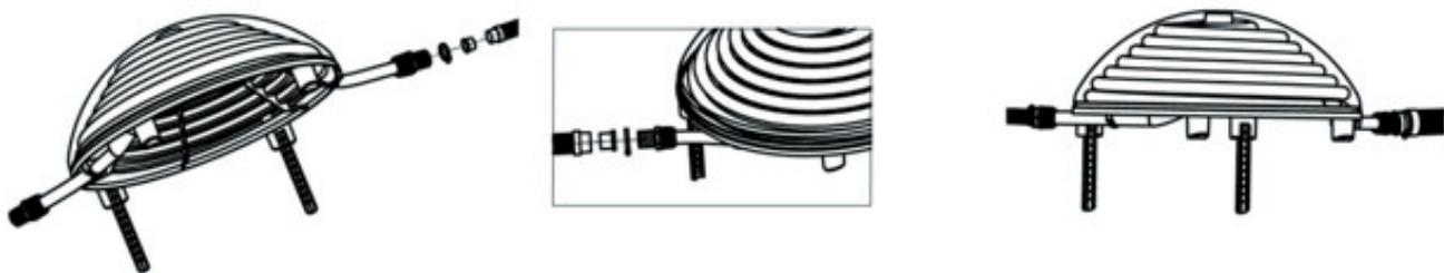
Adaptor pentru furtun de 32 mm: Conectați-l direct la adaptor și fixați-l cu clemele metalice.
