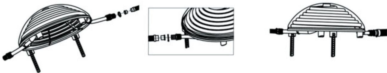
Conexão tubo 32 mm: este é metido directamente no adaptador de conexão e fixado com o colar serrage.
