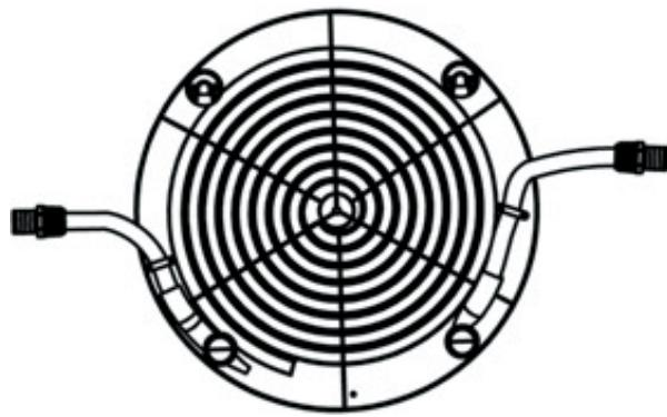
Montez les deux adaptateurs de raccordement sur la partie inférieure de l'installation solaire. Raccordez les tuyaux entre l'installation de filtrage, l'installation solaire et la piscine.
