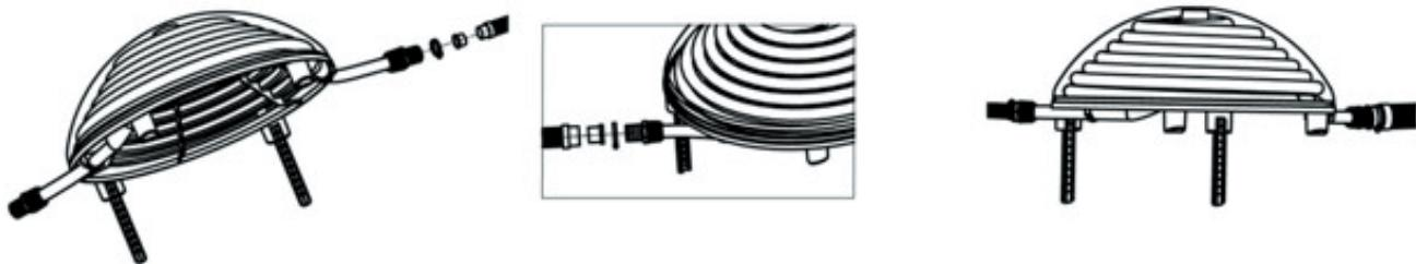
**Schlauchanschluss 32 mm:** Dieser sitzt direkt am Anschlussstück. Mit Metallklammern befestigen
