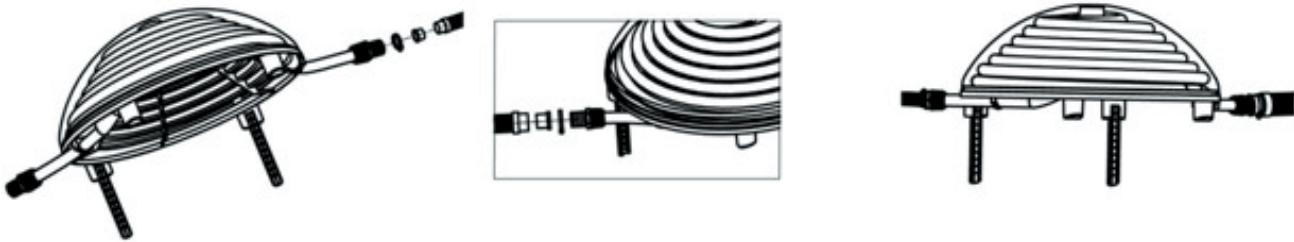
32 mm adaptér hadicotrubky: Připojte přímo na adaptér a upevněte kovovými sponami.
