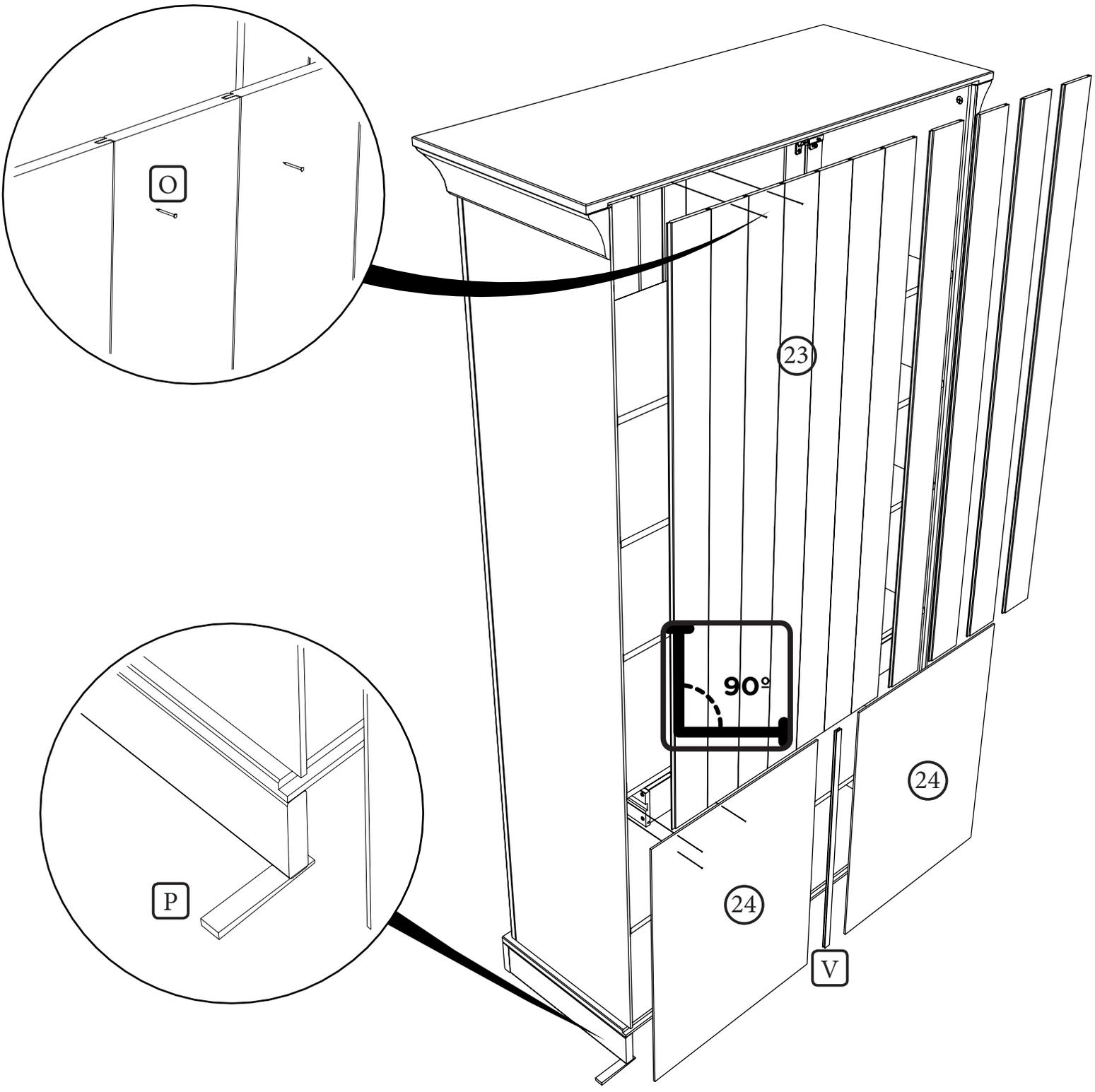
Zum Ausgleich von Bodenunebenheiten und besseren Ausrichten der Türen kann der Unterlegkeil verwendet werden.
