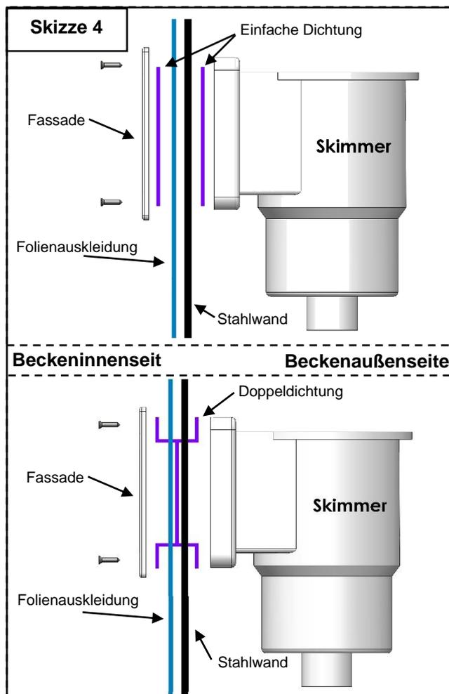
**ACHTUNG:** Ziehen Sie die Schrauben des Skimmers und der Einlaufdüse niemals fest, bevor sich nicht der Wasserstand einige Zentimeter unterhalb des zu montierenden Teils befindet. Die Poolfolie muss durch den Wasserdruck gut gespannt sein.
