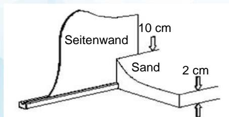
Decken Sie den vorbereiteten Boden mit einem Schutzvlies ab, der 10 bis 12 cm über die Wand hinaus übersteht. Kleben Sie die Schutzfolie an mehreren Stellen mit einem doppelseitigen Kleband an der Wand an. Das Schutzvlies verhindert das Auftreten von Pilzen unter der Poolfolie.
