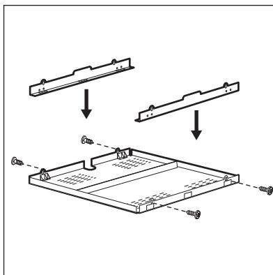
Als u een beveiligingsdoos (een additioneel toebehoren) gebruikt, is de beschermingsvlies onder het fornuis niet noodzakelijk. De beveiligingsdoos is als toebehoren niet in elk land verkrijgbaar. Neem contact op met uw plaatselijke leverancier.
