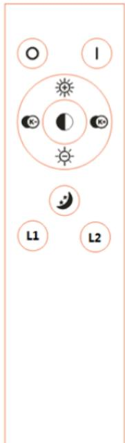
SK: Spárovanie diaľkového ovládača: Po zapnutí stlačte na 3 sekundy toto tlačidlo a podržte ho zhruba po dobu 2 sekúnd. Svetelný zdroj bliká a spárovanie bolo úspešné. Ak sa spárovanie nepodarí, vypnite svetlo na 10 sekúnd a skúste spárovanie zopakovať. Po úspešnom spárovaní sa predchádzajúce spárovanie diaľkového ovládača automaticky vymaže.
