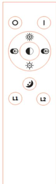
DE: Fernbedienung koppeln: Drücken Sie nach dem Einschalten 3 Sekunden lang die Taste und halten Sie diese für 2 Sekunden lang gedrückt. Die Lichtquelle blinkt und die Koppelung war erfolgreich. Wenn die Koppelung fehlschlägt, schalten Sie die Leuchte für 10 Sekunden aus und versuchen Sie die Koppelung erneut. Die Fernbedienung der vorherigen Koppelung wird automatisch gelöscht, nachdem die Koppelung erfolgreich gepaart wurde.
