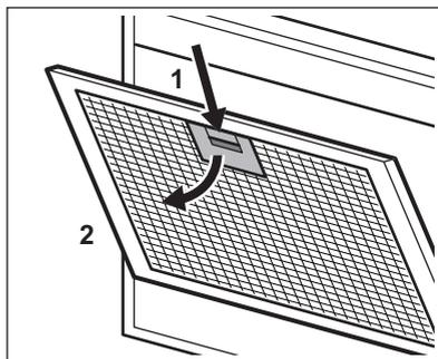
2. Немного наклоните переднюю часть фильтра вниз, а затем потяните.
