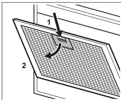
2. Kallutage filtri esiosa kergelt allapoole, seejärel tõmmake.
