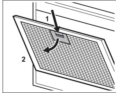
2. Incline ligeramente la parte delantera del filtro hacia abajo y tire de él.
