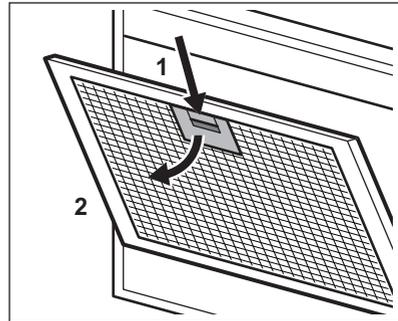
2. Kallista suodattimen etuosaa hiukan alaspäin ja vedä sen jälkeen.
