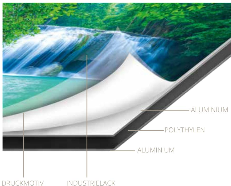
Die spezielle Aluminiumlegierung bietet hohe Korrosionsbeständigkeit, verträgt Temperaturen von -50°C bis über 100°C, dehnt sich bei Wärme nur gering aus und ist sogar in Außenbereichen einsetzbar.
