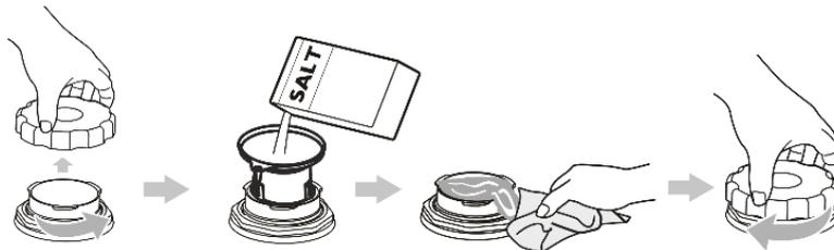
1. Unterkorb entfernen, Deckel des Salzbehälters abschrauben.
