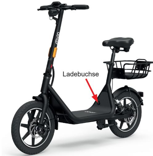
1. Die Ladebuchse befindet sich wie abgebildet am hinteren Ende des Trittbretts.
