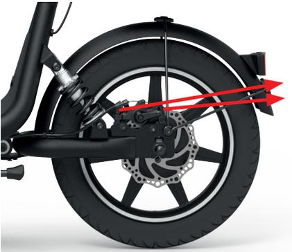
Schrauben der Bremssattelbefestigung
