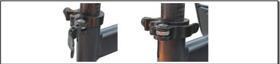
Öffnen Sie den Schnellspanner an der Sattelstützenaufnahme am Rahmen und führen Sie die Sattelstütze ein. Stellen Sie die Sitzhöhe auf eine bequeme Position ein und schließen dann den Schnellspanner.
