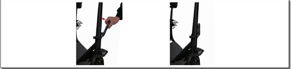
Nehmen Sie den E-Klappscooter aus der Schachtel, ziehen Sie den Verriegelungshebel an der Lenksäule nach vorne und klappen Sie die Lenkstange nach oben. Schieben Sie dann den Hebel wieder zurück.
