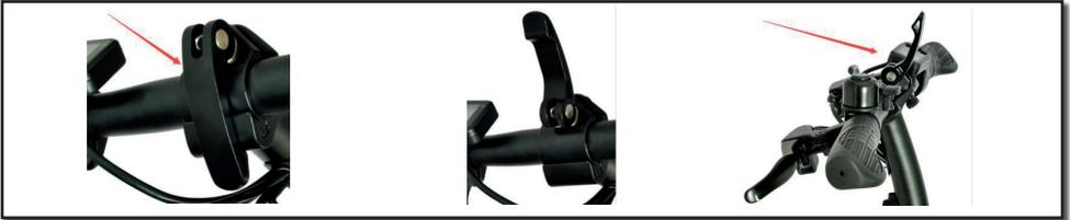
Öffnen Sie den Schnellspanner in der Mitte des Lenkers und drehen den Lenker in eine für Sie komfortable Position. Danach schließen Sie den Schnellspanner.
