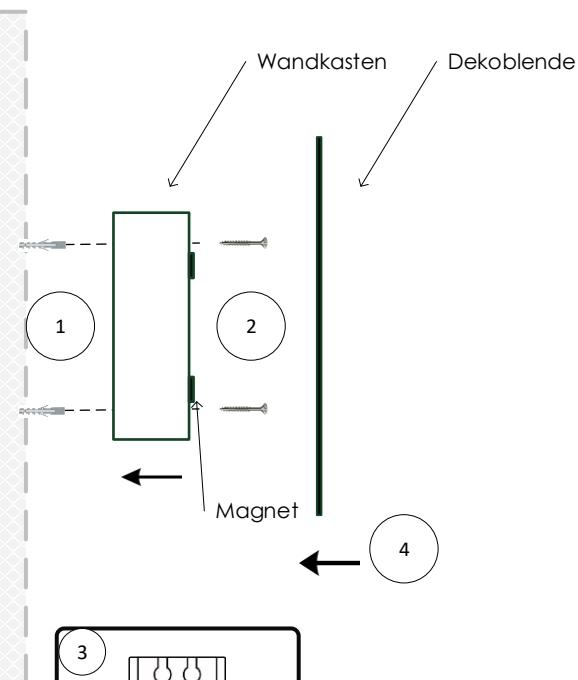
Mit den verschiedenen, beigelegten Abstandshaltern (schwarze Abstandsröhrchen und Sechskant-Verlängerungsbolzen) können Sie den Abstand der Dekoblende zum Wandkasten variieren. Somit besteht die Möglichkeit, mehrere Leuchten optisch teilweise übereinander zu schieben und damit die Kabel von Leuchte zu Leuchte zu verdecken und interessante Lichtkonstellationen zu erstellen
