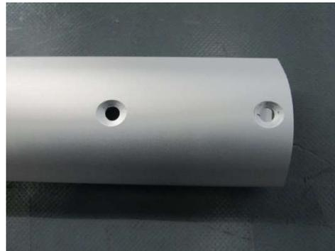
Nieten mit einem Bohrer ausbohren.
