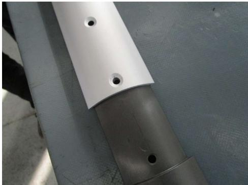
Neuen Handgriff in die Lenkstange einsetzen.
