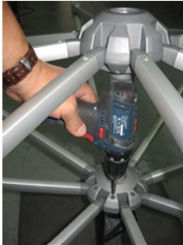
Schrauben an Krone / Schieber mit dem Akku-Schrauber lösen. Krone oder Schieber muss unten liegend sein, um die Schrauben zu lösen.
