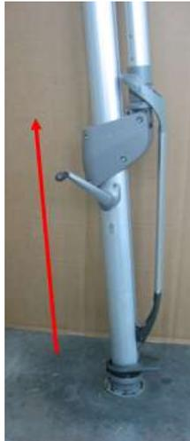
Schrauben am Mast entfernen und Mast vom Drehfuss abziehen.
