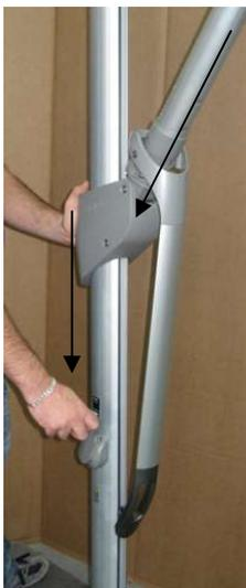
Mit einer Hand die Kurbel drehen und mit der anderen Hand den Wagen nach unten führen (Schliess- und Einfahrbewegung erfolgen simultan).
