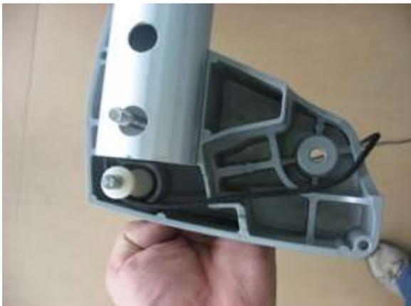
Seil beim Tragarmkopf herausziehen und über die Umlenkrolle führen.
