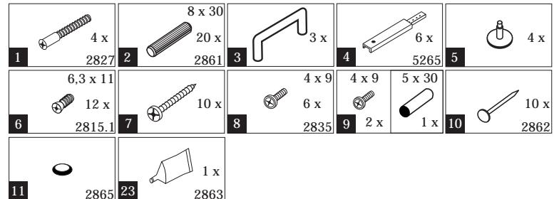
Das beigelegte Wandbefestigungsmaterial (Dübel und Schrauben) eignet sich nur für festes Mauerwerk (z.B.: Beton- oder Ziegelwände). Für andere Wandaufbauten sind eventuell Spezialdübel und andere Schrauben notwendig. Ziehen Sie gegebenenfalls eine Fachkraft zu Rate.
