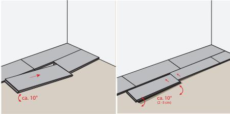
**ERSTE REIHE:** Beginnen Sie mit der Verlegung in einer rechten Raumecke. Legen Sie die erste Diele so, dass die Federseite zur Wand zeigt. Richten Sie diese mit Abstandskeilen exakt aus. Die zweite Diele hebeln Sie mit der stirnseitigen Feder in genauer Verlängerung an die erste stirnseitigen Dielennut ein.
