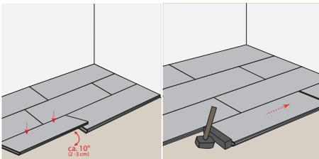
**ERSTE REIHE:** Beginnen Sie mit der Verlegung in einer rechten Raumecke. Legen Sie die erste Diele so, dass die Federseite zur Wand zeigt. Richten Sie diese mit Abstandskeilen exakt aus. Die zweite Diele legen Sie knapp vor die erste Diele und klopfen diese mittels Schlagklotz und Hammer zusammen. Achten Sie dabei, dass die Dielen bündig sind.
