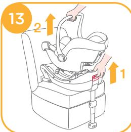
8. Zur Entriegelung der ISOFIX-Konnektoren gehen Sie wie folgt vor: Im ersten 14 -1 Schritt betätigen Sie den Sicherungsknopf 14 -2, halten diesen gedrückt (System ist entsichert) und betätigen gleichzeitig den seitlichen Entriegelungsknopf am ISOFIX-Konnektor 14.
