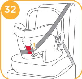
3. Ziehen Sie am Schultergurt des Fahrzeugs, um das Babyschalenmodul fest und sicher zu verankern. 33
