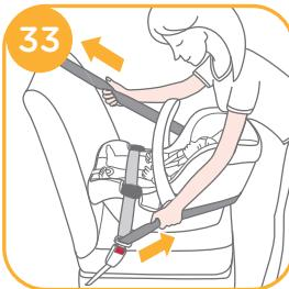
4. De horizontale lijn op de babydraagmodule moet evenwijdig met de grond zijn als de babydraagmodule is geïnstalleerd. 34
