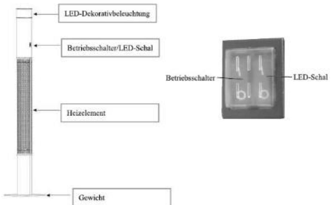
Schalten Sie das Heizelement mit dem Betriebsschalter ein/aus. (I) für 1500W. Die (0) -position ist ausgeschaltet.
