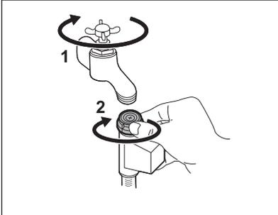
3. Entfernen Sie mithilfe einer Zange den Wasserzulauffilter und die Gummidichtung.
