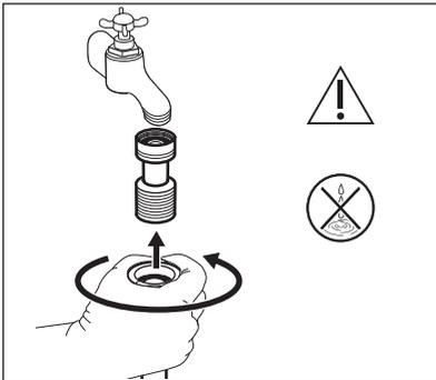
**Zum Schutz des Trinkwassers muss das beiliegende Rückschlagventil zwischen dem Wasserhahn und dem Wasserversorgungsschlauch installiert werden.**
