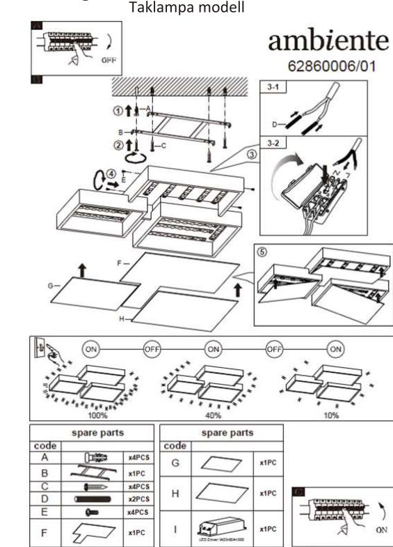
**OBS:** Strömförsörjningen går genom kopplingsdosans öppning till takkoppens kopplingssplint. Säkerställ att metallsockelns och monteringsytans kablar skiljs med en dubbel isolering och att anslutningarna L, N har kopplats ihop som visat på bilden.
