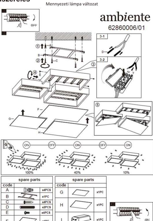
**FIGYELEM:** Az áramellátás és lámpacsatlakozó doboz nyílásán keresztül a mennyezeti rózsában található sorkapocsba vezet. Győződjön meg arról, hogy a vezetékek duplán szigeteltek, el vannak választva a fém talapzattal és a szerelőfelülettel, ill. hogy az L, N csatlakozók az ábrázolt módon vannak összekötve.
