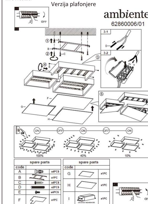
**NAPOMENA:** Strujno napajanje vodi kroz otvor priključne kutije svetiljke do redne stezaljke u čašici za plafon. Proverite da li su kablovi od metalnog kućišta i montažne površine razdvajeni dvostrukom izolacijom i da li su priključci L i N povezani kao što je prikazano na slici.
