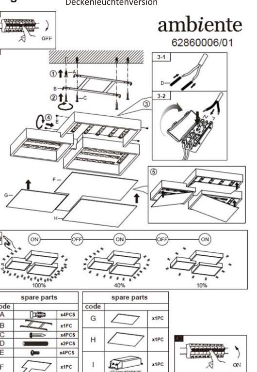
**HINWEIS:** Die Stromversorgung führt durch die Öffnung der Leuchtenanschlussbox in die Lüsterklemme im Baldachin. Stellen Sie sicher, dass die Verkabelung vom Metallsockel und der Montagefläche durch eine Doppelisolierung getrennt ist und, dass die Anschlüsse L, N wie angezeigt verbunden sind.
