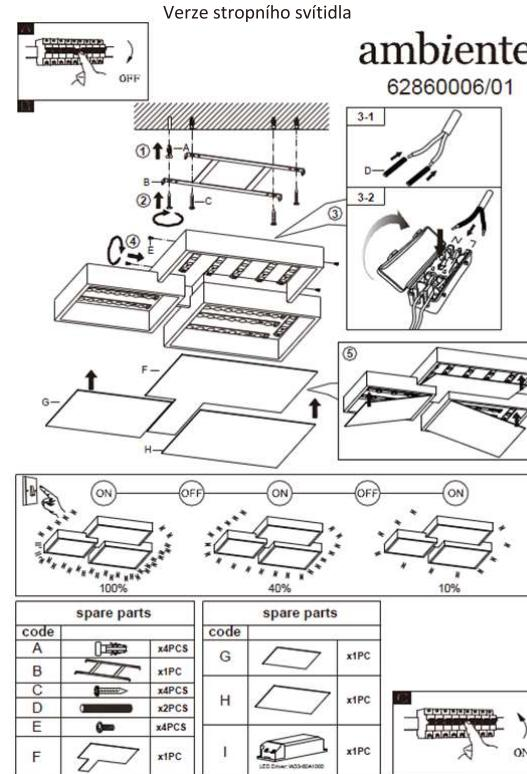
**UPOZORNĚNÍ:** zdroj napájení vede otvorem napájecího boxu svítidla do úchytky svítidla v ochranném krytu. Ujistěte se, že je kabeláz od kovového podstavce a montážní plochy oddělená dvojitou izolací a přípojkou L, N jsou spojeny tak, jak je zobrazeno na obrázku.
