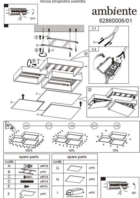
**UPOZORNENIE:** napájanie vede cez otvor napájacieho boxu svetidla do svorkovnice v ochrannom kryte. Uistite sa, že je kabeláz od kovového podstavca a montážnej plochy oddelená dvojitou izoláciou a svorky L, N sú spojené tak, ako je to znázornené na obrázku.
