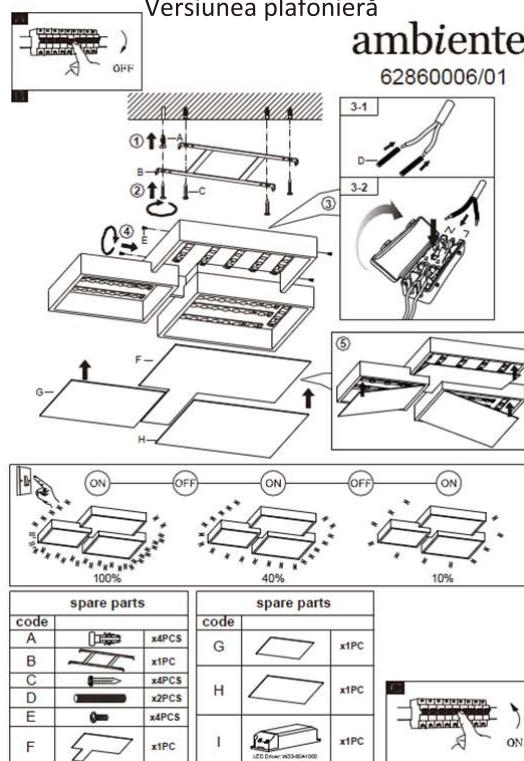
**INDICAȚIE:** Curențul electric trece prin deschizătura cutiei de jonctiune în terminalul cu șurub din baldachin. Cablurile soclului de metal și suprafetei de montare trebuie să fie separate printre izolație dublă, iar mufele L, N sunt conectate precum vă este ilustrat.
