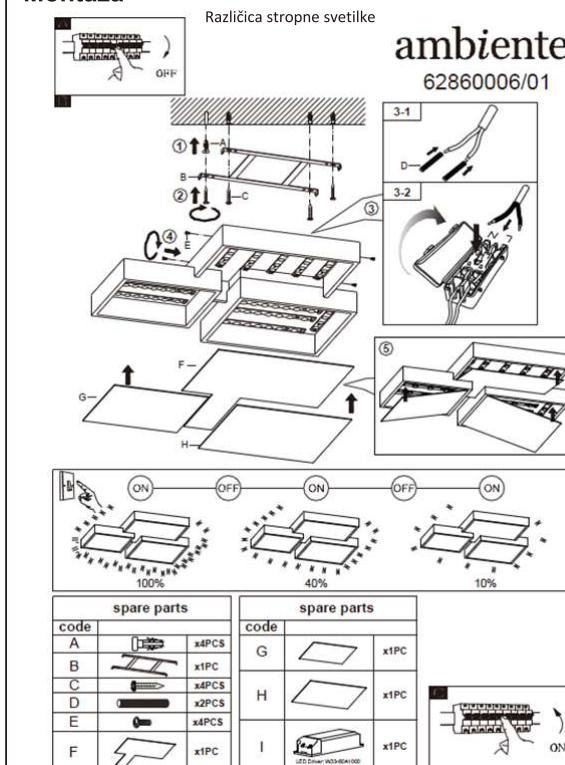
**NASVET:** Napajanje vodi skozi odprtino priključne škatle svetilke v sponko svetilke v baldahinu. Prepričajte se, da so kabli ločeni od kovinskega podnožja in montažne površine z dvojno izolacijo in da sta priključka L in N povezana, kot je prikazano.
