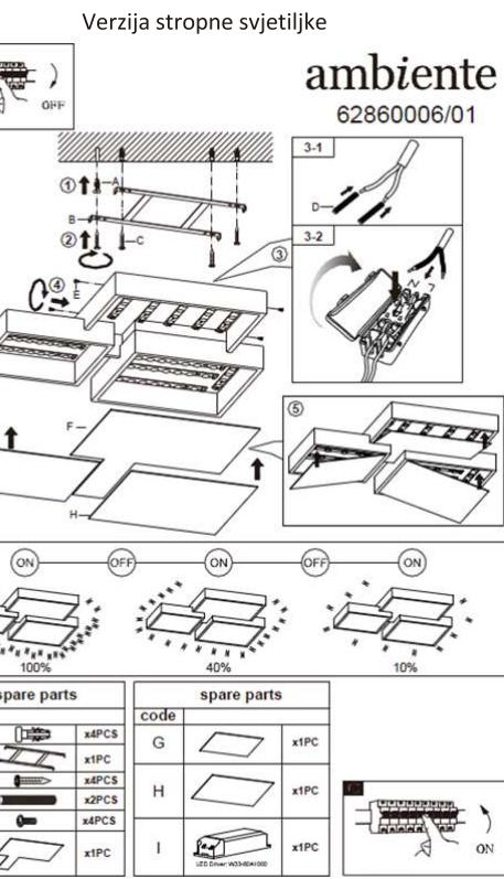
**NAPOMENA:** Napajanje strujom vodi kroz otvor priključne kutije svjetiljke u rednu stezaljku u baldahinu. Osigurajte da je ožičenje dvostrukou izolirano, da je dvostrukom izolacijom odvojeno od metalnog postolja i površine za montažu i da su priključci L i N spojeni, kao što je prikazano na slici.
