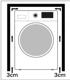
Die Positionierung des Gerätes unter einer Arbeitsplatte kann nur erfolgen, wenn die Mindestabstände entsprechend der Darstellung eingehalten werden können.
