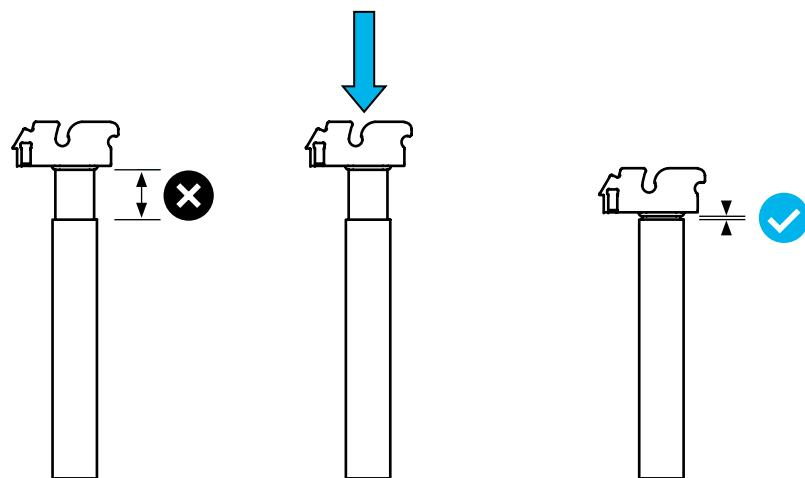
Kippe die Säule und setze sie mit Hilfe der Führungsnut korrekt auf den Träger. Drücke die Säule in eine aufrechte Position.
