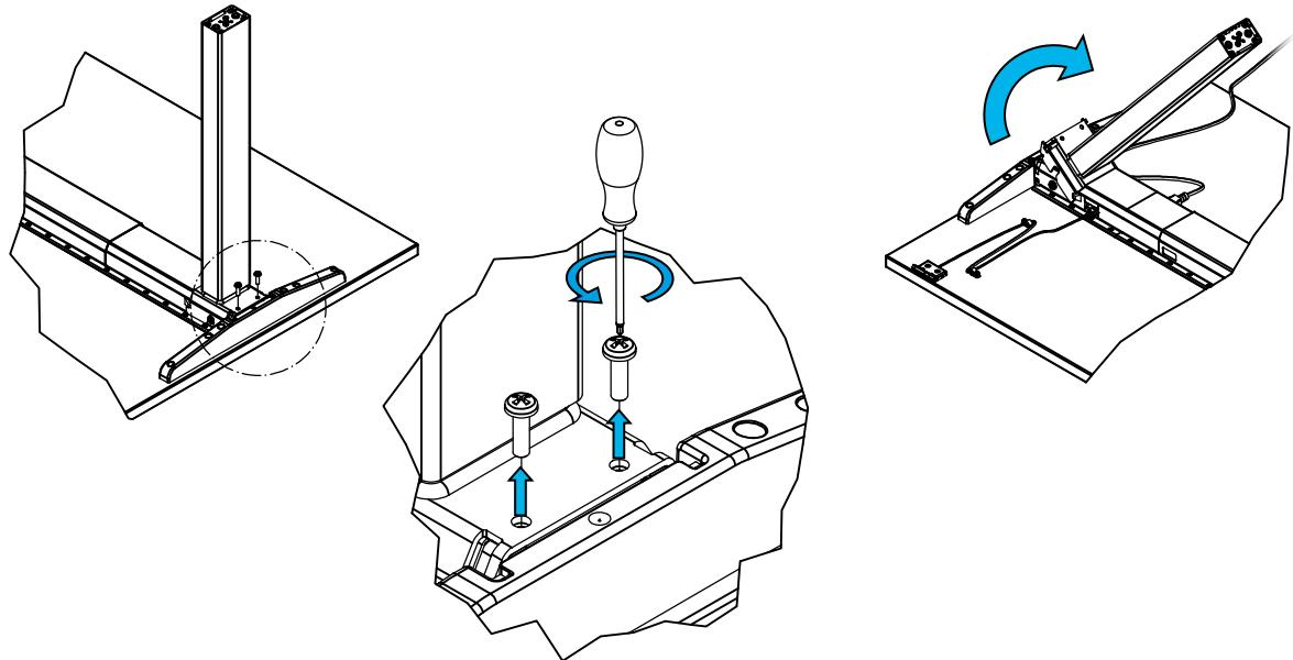
6. Schraube das Bedienelement und die Kabelklemmen ab.
