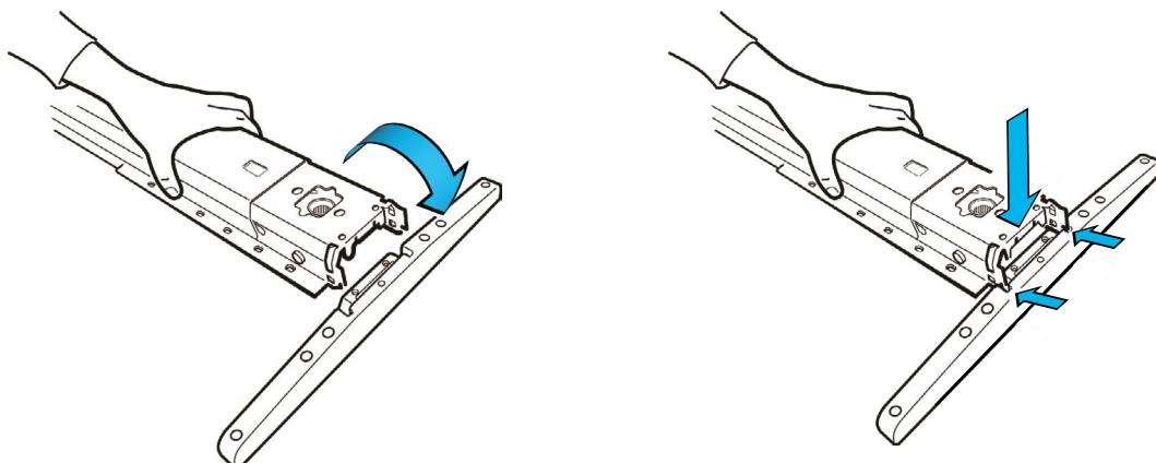
Drücke den Träger mit der Hand fest nach unten, um den Plattenträger am Träger zu befestigen. Anschließend wiederholst du die Schritte mit dem zweiten Plattenträger.
