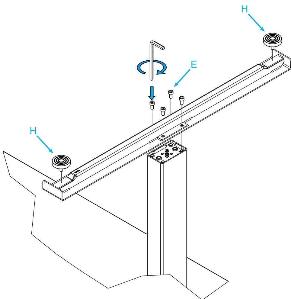
Drehe den Tisch nun um und bringe ihn mit Hilfe der Einstellschrauben (H) in die Waage.
