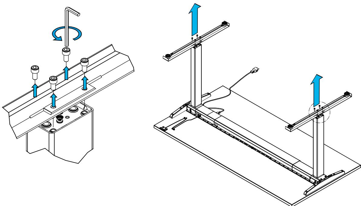
5. Schraube die Säulen ab und entferne sie mit einer Drehbewegung.
