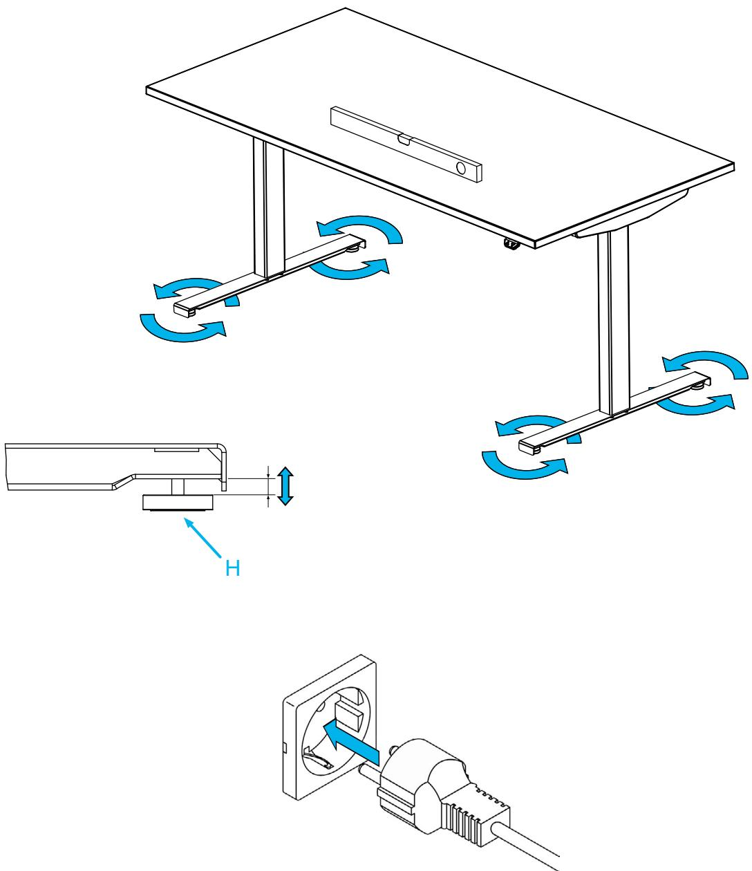
Schließe den Tisch an das Stromnetz an. Um den Tisch bei der ersten Inbetriebnahme einmal zu kalibrieren, fahre ihn einmal ganz nach oben und einmal ganz nach unten, bevor du ihn auf die gewünschte Höhe bringst.
