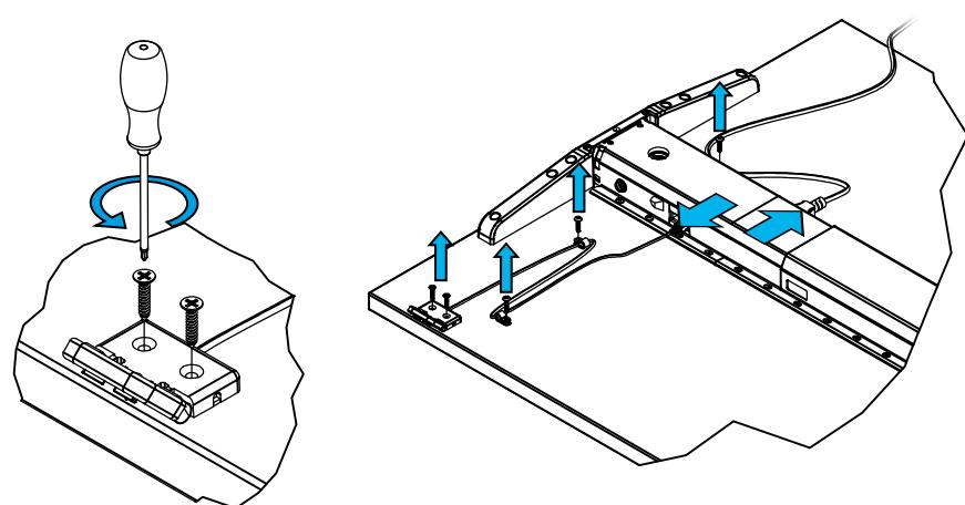
7. Schraube Plattenträger und Träger von der Tischplatte ab.
