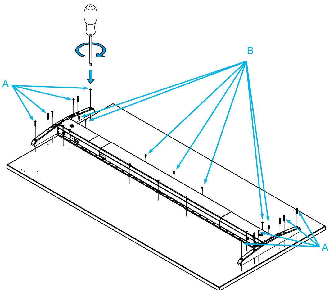
! Die Befestigungsbohrungen an den Verlängerungspunkten sind aufgrund der variablen Breiteneinstellung nicht vorhanden. Die Bohrungen sind optional (um ein Ausreißen der Melaminplatte zu verhindern) und müssen bei Bedarf von dir selbst gebohrt werden.
