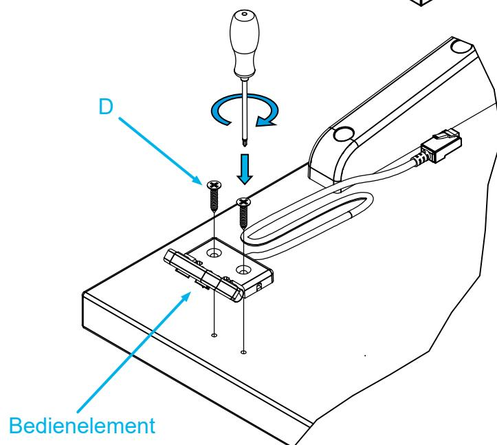
Montiere das Bedienelement so, dass die Tasten nach unten zeigen. Wenn der Tisch später umgedreht wird, sind die Tasten dann oben und bequem zu bedienen.
