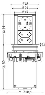
Steckdosenelement zum versenken in die Arbeitsplatte, durch Druck auf den Deckel öffnet das System selbstständig - für Plattenstärke von 16 - 60 mm
