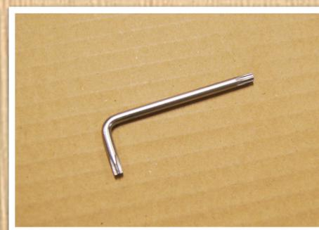
Schrauben Sie an jedes Tischbein eine von 4 Schrauben mit einem Sechskantschlüssel (empfohlenes Endstück: T25) oder Flachschraubenschlüssel mit 6 mm ein. Die Schraube sollte etwa 3-4 cm herausragen, so dass sie sich an das zuvor montierte verbindende Metallelement im Kasten festschrauben lässt.
