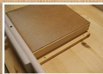
Die Montage der Schublade ist mit ihrem Einschieben an die vorbereite Stelle im Kasten zu beginnen. Anschließend sind die Holzführungen zwischen die Schublade und die Tischplatte zu platzieren und mit einem Schraubendreher oder Kreuzakkuschrauber festzuschrauben.
