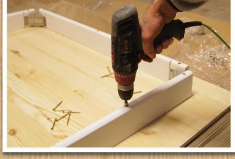
Schrauben Sie den Kasten mit einem Kreuzschraubendreher oder Akkuschrauber an der Tischplatte fest. Beim Einschrauben ist darauf zu achten, dass die Schraube die Tischplatte nicht durchbohrt.
