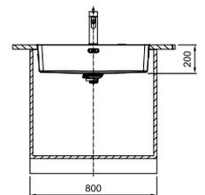
Die Arbeitsplatte muss im Bereich des Überlaufes, gemäß Montageanleitung, ausgeschnitten werden.
