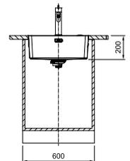
Die Arbeitsplatte muss im Bereich des Überlaufes, gemäß Montageanleitung, ausgeschnitten werden.
