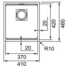
Schlichtes Design mit besonders schmalen Beckenradius. Die eingearbeitete praktische zweite Arbeitsebene bietet maximale Funktionalität in der Küche. Das Material Fraganite ist besonders hygienisch und leicht zu reinigen. Inklusive hochwertiger quadratischer Abdeckkappe aus rostfreiem Edelstahl.
