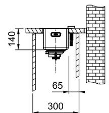
Bei Einbau von oben (Slimtop/ Flächenbündig) muss die Arbeitsplatte im Bereich des Überlaufes, gemäß Montageanleitung, ausgeschnitten werden.
