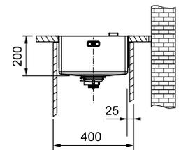
Bei Einbau von oben (Slimtop/Flächenbündig) muss die Arbeitsplatte im Bereich des Überlaufes, gemäß Montageanleitung, ausgeschnitten werden.
