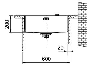
Bei Einbau von oben (Slimtop/Flächenbündig) muss die Arbeitsplatte im Bereich des Überlaufes, gemäß Montageanleitung, ausgeschnitten werden.
