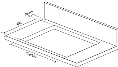
Für den flächenbündigen Einbau umlaufend
