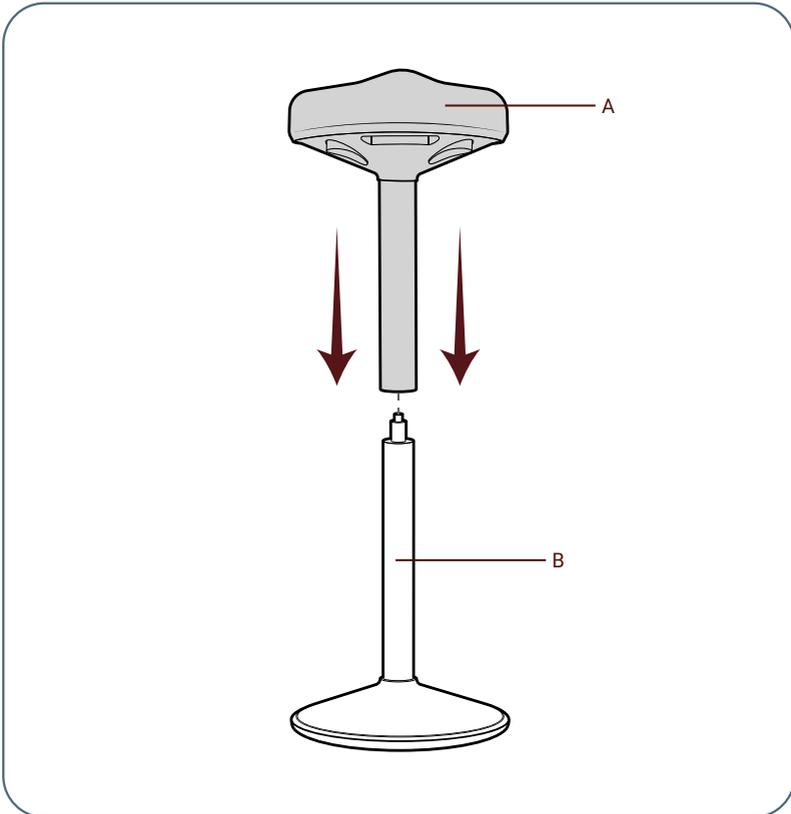
Stellen Sie bitte sicher, dass alle Komponenten sicher zusammengebaut und fest miteinander verbunden sind, ehe Sie sich unkontrolliert und mit vollem Körpergewicht auf den Sitzhocker setzen.
