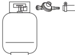
4. Schrauben Sie die Überwurfmutter am Druckregler auf die Verschraubung der Gasflasche. Benutzen Sie **KEIN** Werkzeug, um die Dichtung nicht zu beschädigen!
