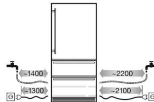
Inklusive 3 m Panzerflexschlauch für Festwasseranschluß 3/4"
