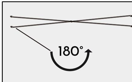
**D** Drehe nur eine der zwei Metallleisten um 180°, dann passen sie genau auf die Beine. Die vier Schrauben einfach mit etwas Druck in die Holzbeine reinschrauben.
