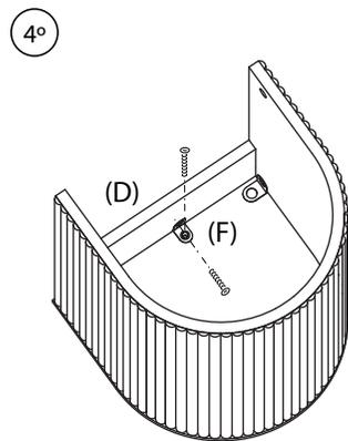
4° Schrauben Sie zwei L-förmige Metall (F) an die Holzplanke (D), um alle Teile zu befestigen.
