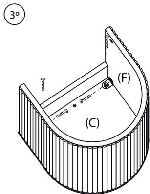
3° Setzen Sie zwei L-förmige Metallteile (F) ein, um den unteren Deckel (C) zu befestigen.
