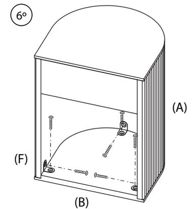
6° Zum Schluss schrauben Sie drei L-förmige Metallteile (F) in den oberen Deckel (B) und in die flexible Platte (A).
