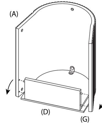
2° Legen Sie das Holzstück (D) an seinen Platz. Biegen Sie dann die Seiten der flexiblen Platte (A) vorsichtig in Richtung des Holzstücks (D), so dass sie in die Holzdübel (G) passt.
