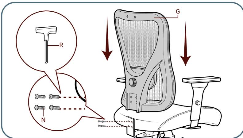
**Schritt 6: Befestigen Sie die Kopfstütze an der Rückenlehne.**
