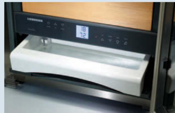
In den integrierten Wasserbehälter kann ein Liter destilliertes Wasser eingefüllt werden. Feuchtigkeitssensoren regeln den Wasserbedarf und gewährleisten präzise die gewählte **Luftfeuchtigkeit zwischen 68 % und 75 %**. Eine optische Anzeige informiert rechtzeitig, wenn Wasser nachgefüllt werden muss.
