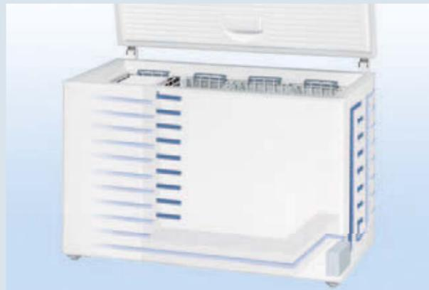
Der **Verflüssiger** für die Kälteerzeugung ist ringsum in die Außenhaut glatt eingeschäumt. Dadurch arbeitet das Gerät vibrationsarm und leise. Am Gehäuse bildet sich kein Schwitzwasser, und die glatte Außenhaut lässt sich leicht reinigen.
