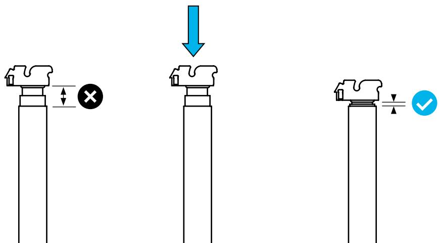
Kippe die Säule und setze sie mit Hilfe der Führungsnut korrekt auf den Träger. Befestige die Säule am Träger, indem du sie nach unten drückst, bis ein Klicken zu hören ist und beide Klauen die Säule in der richtigen Position arretieren.
