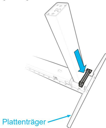
7. Drücke gerade nach unten, um den Plattenträger zu lösen und die Klaue von der Säule zu entriegeln.
