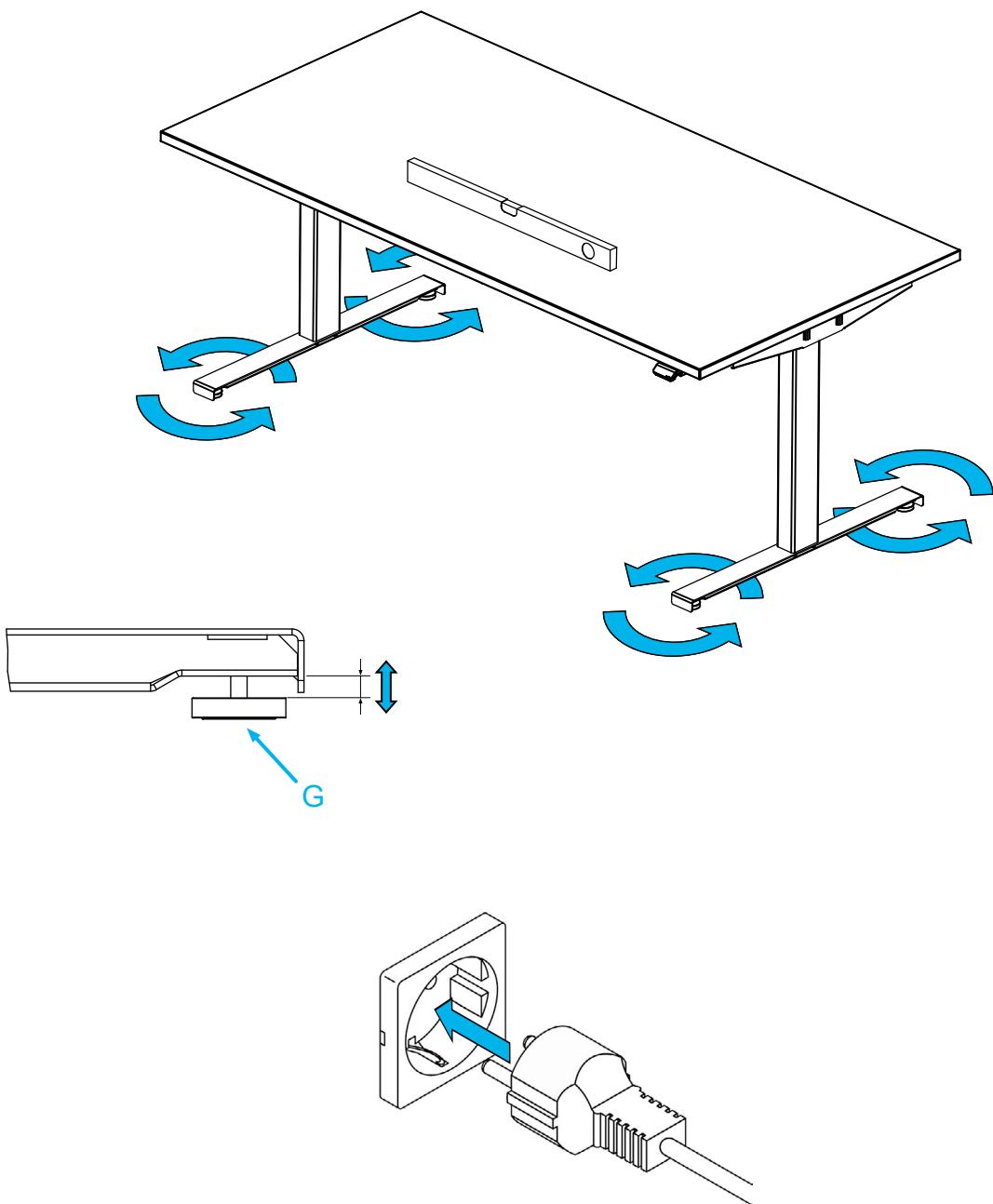
Schließe den Tisch an das Stromnetz an. Um den Tisch bei der ersten Inbetriebnahme einmal zu kalibrieren, fahre ihn einmal ganz nach oben und einmal ganz nach unten, bevor du ihn auf die gewünschte Höhe bringst.
