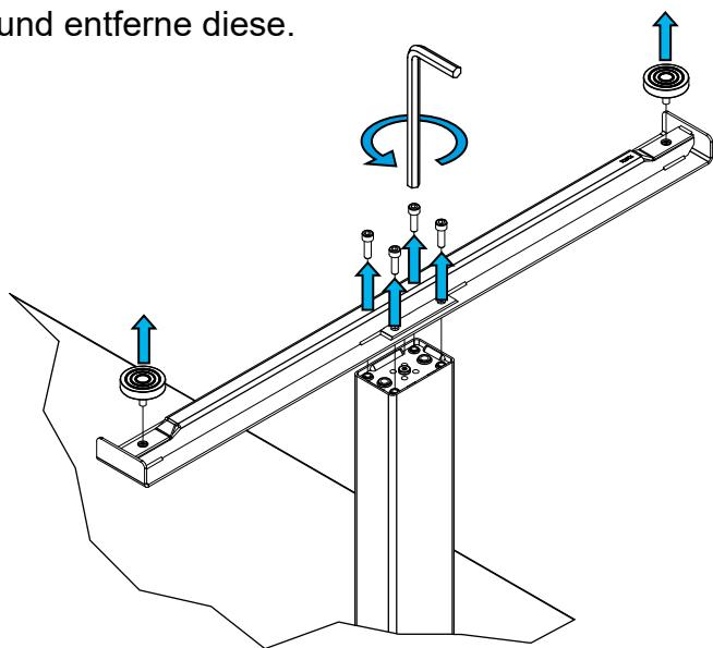
6. Für das Abnehmen der Säulen wird ein Demontagewerkzeug benötigt.
