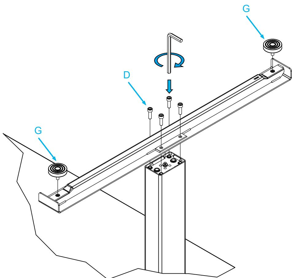
Drehe den Tisch nun um und bringe ihn mit Hilfe der Einstellschrauben (G) in die Waage.
