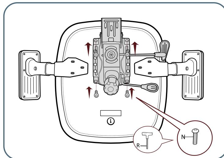
Setzen Sie das Metallverbindungsstück (**Teil J**) ein und richten Sie dieses mit den drei vorgefertigten Löchern des Mechanismus aus. Ziehen Sie das Verbindungsstück dann mit dem Sitzmechanismus unter Verwendung der mitgelieferten Unterlegscheiben , Federringe und Metallverbindungsstückschrauben (**Teil O**) sowie dem Innensechskantschlüssel (**Teil R**) fest.
