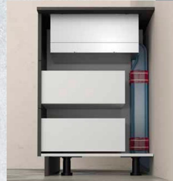
Der vertikale 90° „S“ Bogen mit sehr engem Radius lässt die Luftführung\* innerhalb des Möbels verlaufen und bietet in Abhängigkeit von der Arbeitstieftiefe eine Auszugstiefe von mindestens 44,8 cm. Dies ermöglicht Arbeitstieftiefen ab 60 cm.
