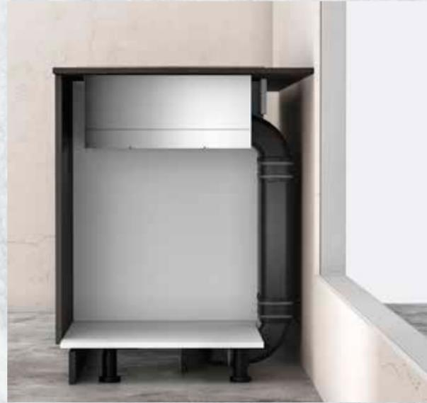
An nicht isolierten Außenwänden wird eine Planung in einer teil- oder vollgeführten Umluftkonfiguration empfohlen, um eventuelle Kondensationsrisiken zu minimieren.
