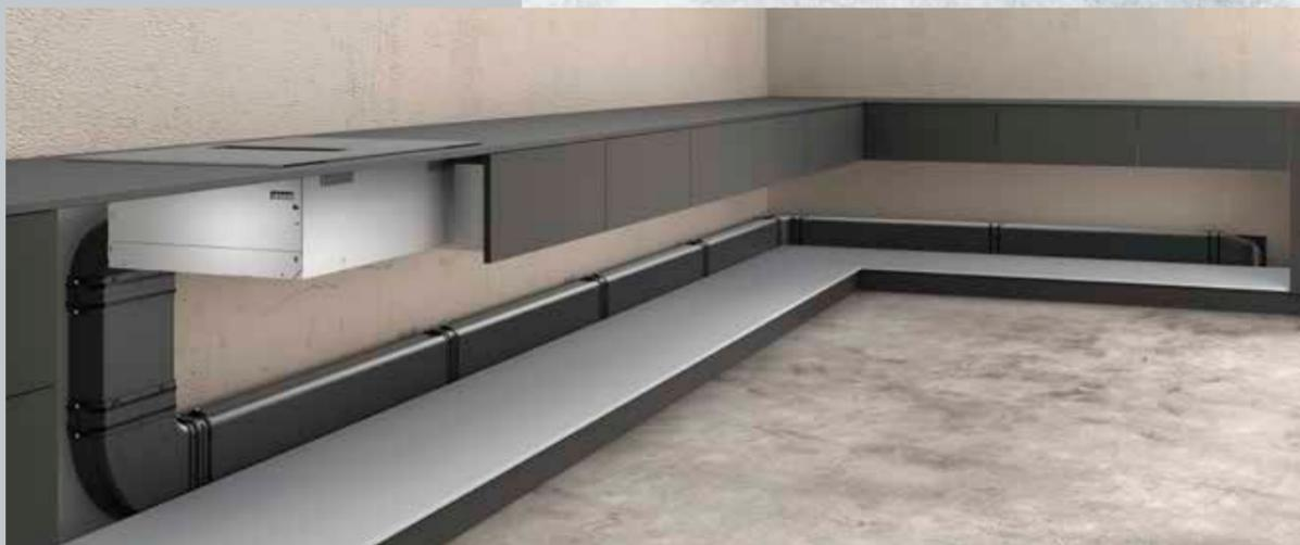
Das druckstabile Gebläse mit moderner und effizienter BLDC-Technologie erlaubt auch längere und komplexere Luftführungen bis zu 8 Metern mit vier 90°-Bogen und behält dabei eine angemessene Leistungsfähigkeit. Dies deckt einen sehr großen Teil aller Abluftplanungen ab. Auch noch längere Verrohrungen sind möglich, jedoch senkt dies die Abzugsleistung des integrierten Lüftungssystems weiter ab.
